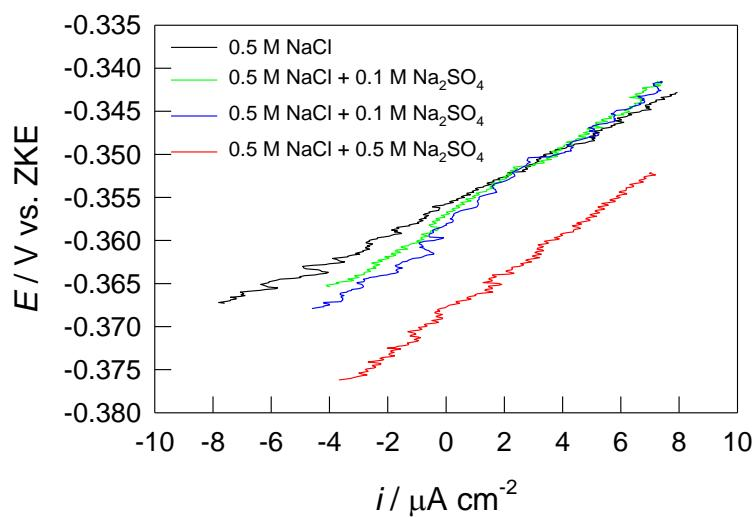
**Slika 21.** Prikaz linearnih dijelova polarizacijskih krivulja dobivenih mjeranjima metodom linearne polarizacije za CuAlMn leguru u elektrolitu različitog sastava
