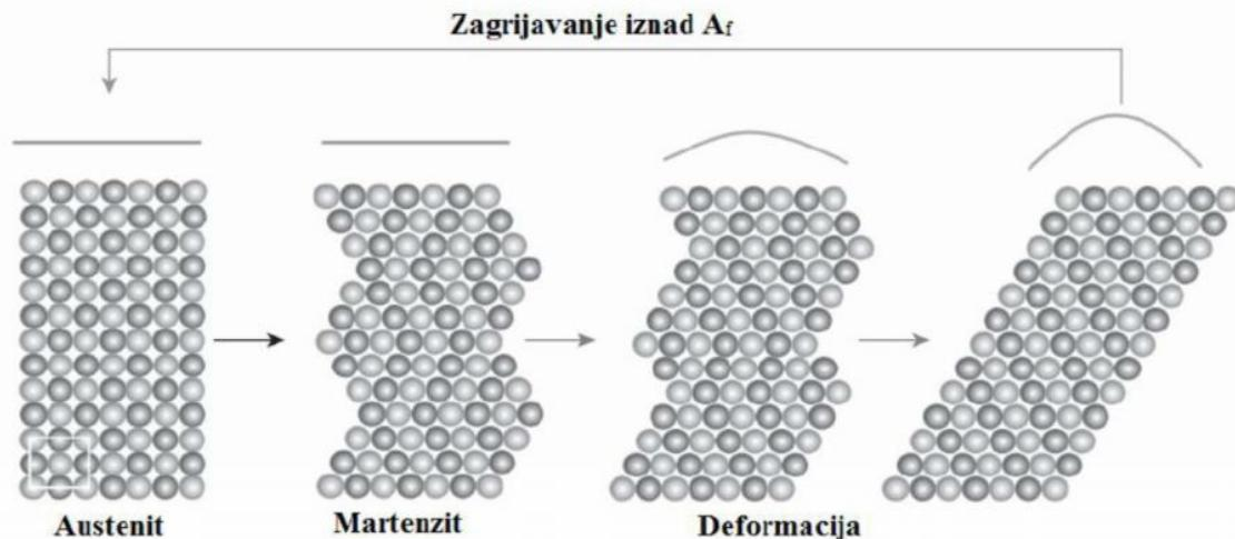
Slika 5. Mehanizam efekta prisjetljivosti oblika<sup>(14)</sup>
