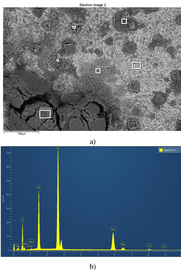
**Slika 28.** SEM snimka dijela površine a) i pripadajuća EDS analiza za poziciju 1 (Spectrum 1) b) za CuAlMn leguru nakon potenciodinamičke polarizacije u  $0.5 \text{ mol dm}^{-3}$  NaCl otopini bez ultrazvučnog ispiranja površine.
