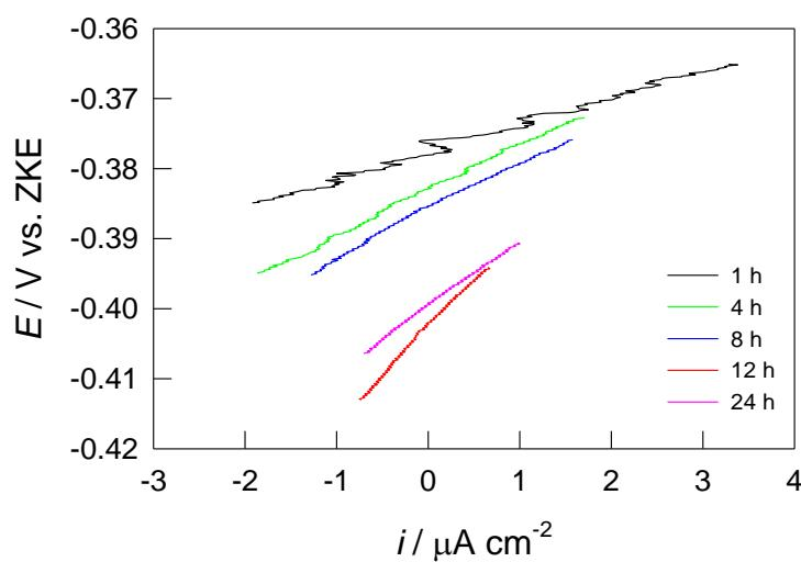
**Slika 23.** Prikaz promjena nagiba linearnih dijelova polarizacijskih krivulja dobivenih mjeranjima metodom linearne polarizacije za CuAlMn leguru u  $0.5 \text{ mol dm}^{-3}$  NaCl i  $0.5 \text{ mol dm}^{-3}$   $\text{Na}_2\text{SO}_4$  u vremenskom periodu od 24 h
