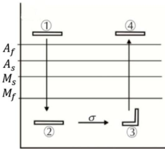
**Slika 6.** Shematski prikaz jednosmjernog efekta prisjetljivosti oblika<sup>(11)</sup>
