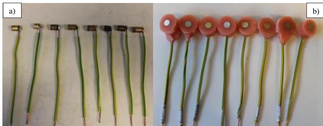
**Slika 15.** Izrada elektroda za elektrokemijska mjerena
