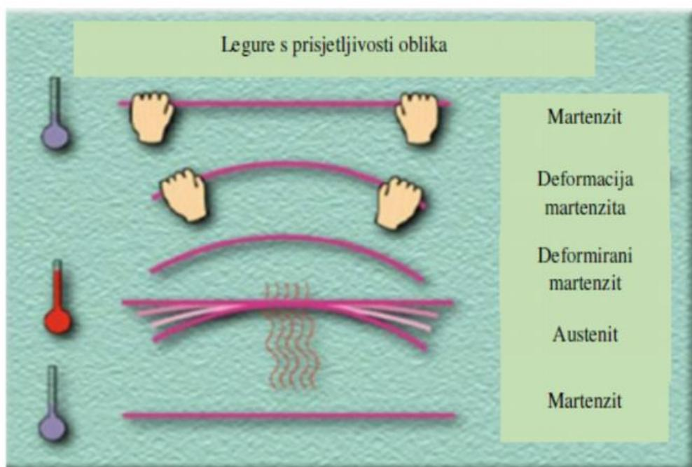
Slika 2. Transformacije legura s efektom prisjetljivosti oblika<sup>(10)</sup>
