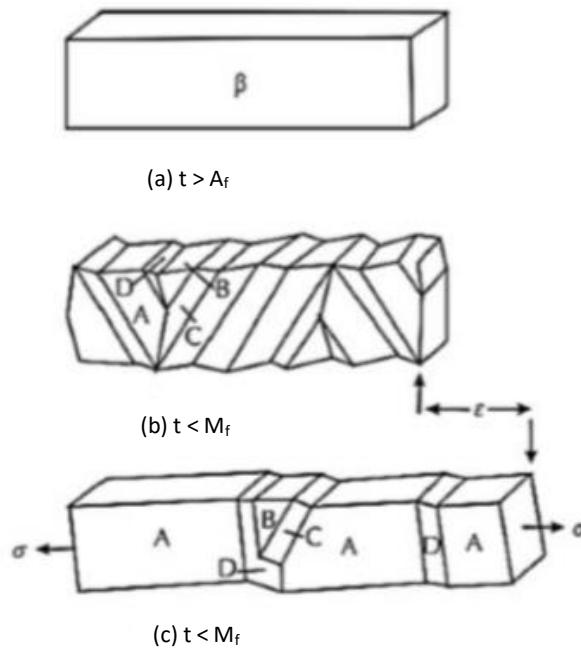
**Slika 3.** (a) Shematski prikaz  $\beta$  faze kristala, (b) spontano nastali martenzit (A, B, C, D – sraslačke varijante nakon hlađenja i transformacije u martenzit), (c) martenzitna struktura nakon podvrgavanja naprezanju<sup>(11,12)</sup>
