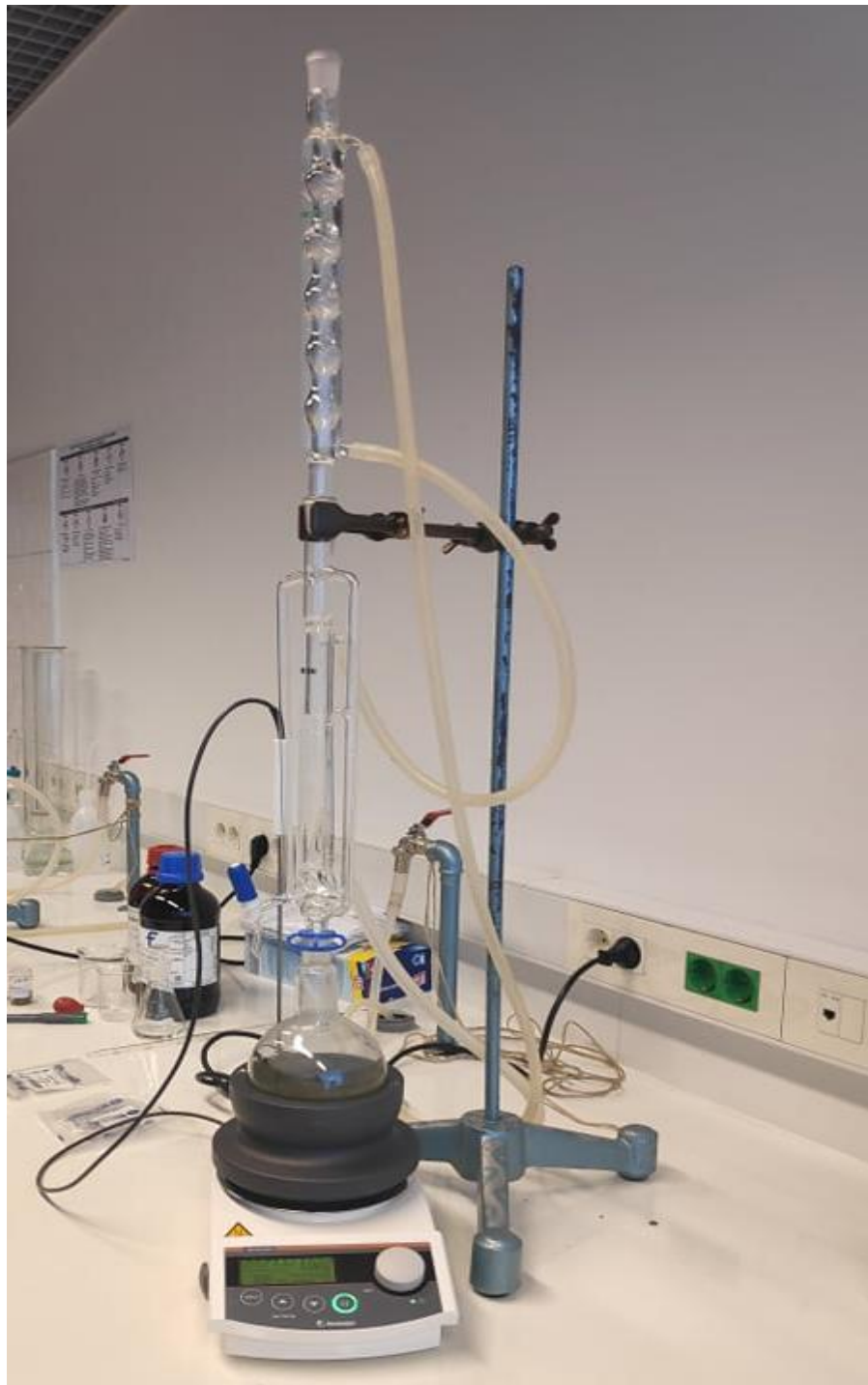
Slika 10. Modificirana aparatura prema Clevenger-u.
