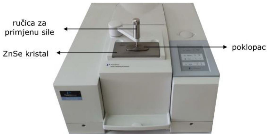
Slika 17. FT-IR spektrometar Spectrum One (Perkin-Elmer, SAD) s dodatkom za snimanje HATR tehnikom 13
