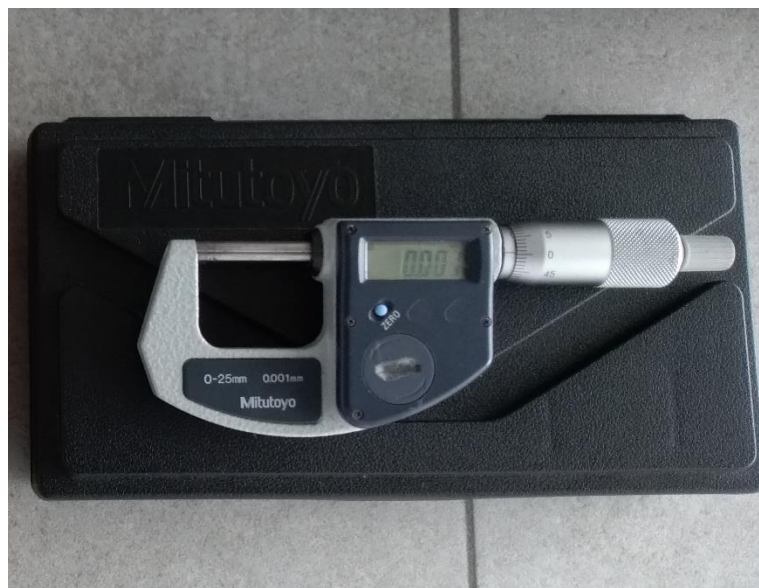
Slika 16. Digitalni mikrometar Mitutoyo
