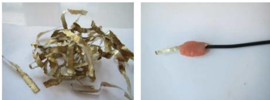
Slika 21. a) Traka legure dobivena postupkom brzog hlađenja, b) pripremljena elektroda za elektrokemijska mjerenja
