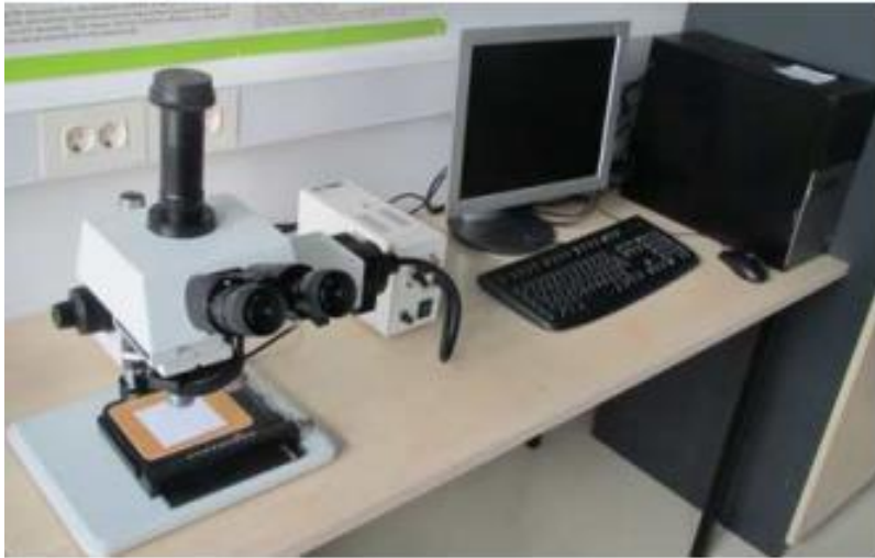
Slika 24. Optički mikroskop MXFMS-BD, Ningbo Sunny Instruments co.
