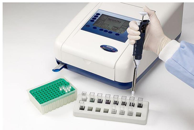
**Slika 10.** Spektrofotometar
