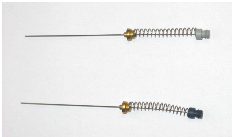
Slika 9. Vlakna s ovojnicama DVB/CAR/PDMS (sivo vlakno) i PDMS/DVB (plavo vlakno) 19
