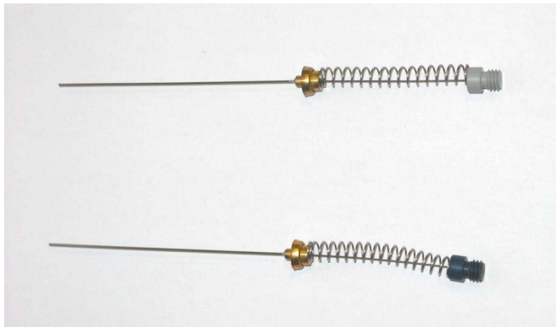
Slika 9. Vlakna s ovojnica DVB/CAR/PDMS (sivo vlakno) i PDMS/DVB (plavo vlakno) 19
