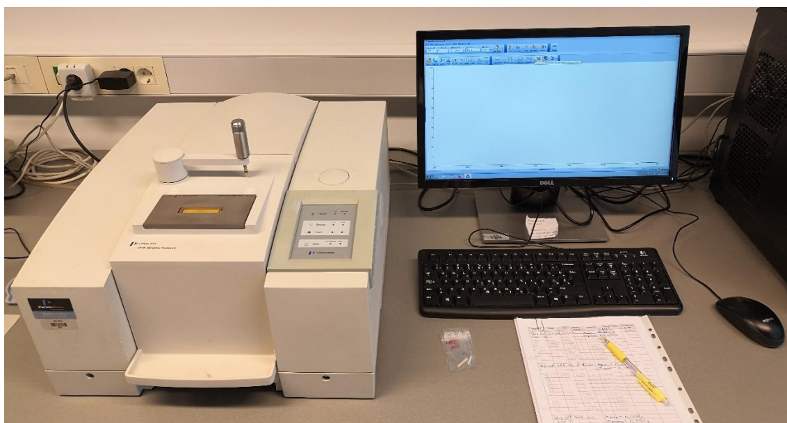
Slika 2.4. Perkin-Elmer IR spektrometar s HATR dodatkom i pratećim Spectrum One programom
