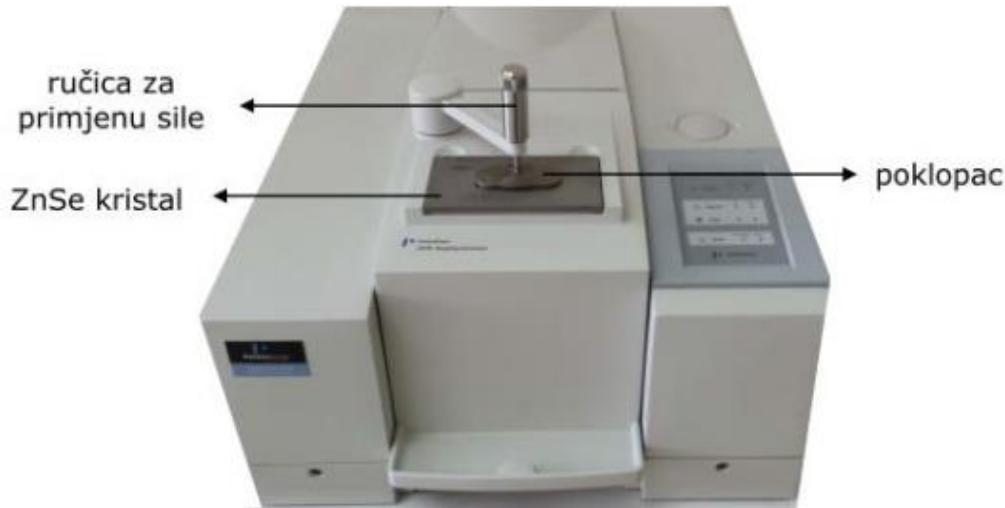
Slika 1.11. Perkin-Elmer Spectrum One spektrometar s dodatkom za snimanje HATR tehnikom<sup>36</sup>
