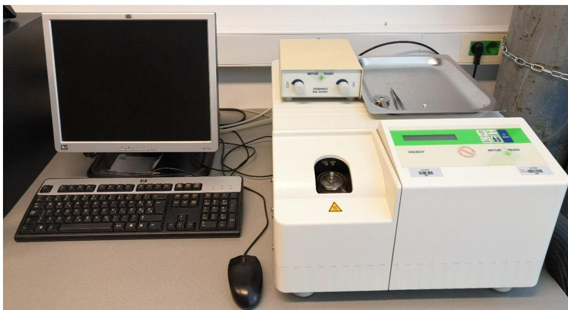
Slika 2.5. Diferencijalni pretražni kalorimetar Mettler-Toledo DSC 823<sup>e</sup> s pratećim programom STAR<sup>e</sup>
