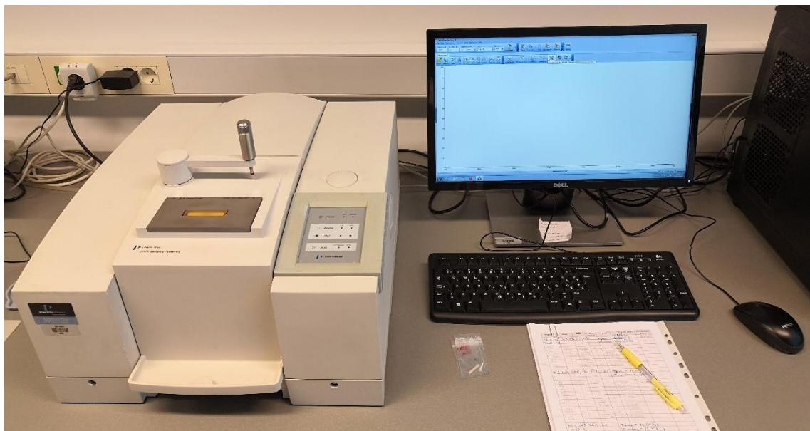
Slika 2.4. Perkin-Elmer IR spektrometar s HATR dodatkom i pratećim Spectrum One programom
