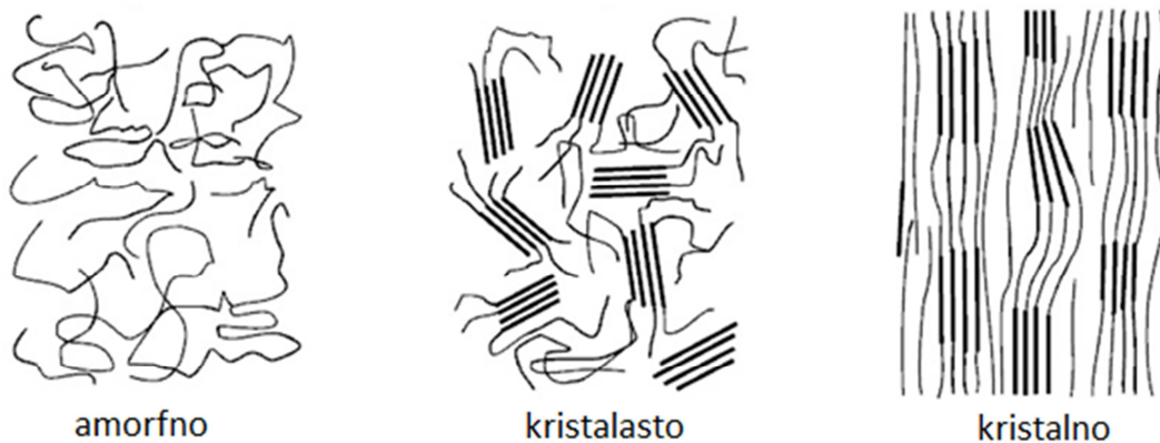
Slika 1. Nadmolekulna struktura polimera 10
