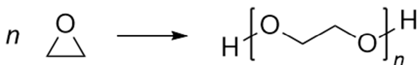
Slika 3. Opća reakcija sinteze i strukture poli(etilen-oksida) 15
