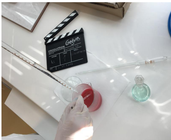
Slika 2-6 Dodavanje alkoholne otopine dimetilglioksima
