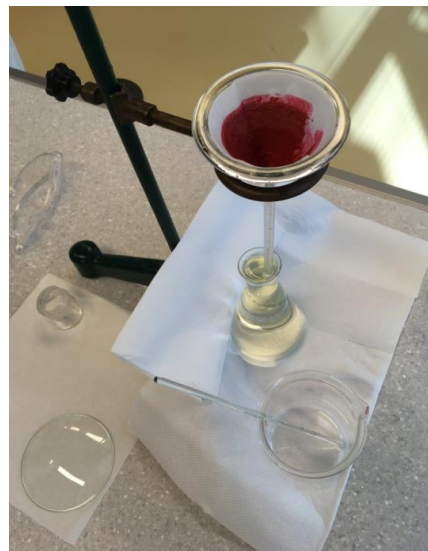
Slika 2-8 Filtracija otopine kroz lijevak
