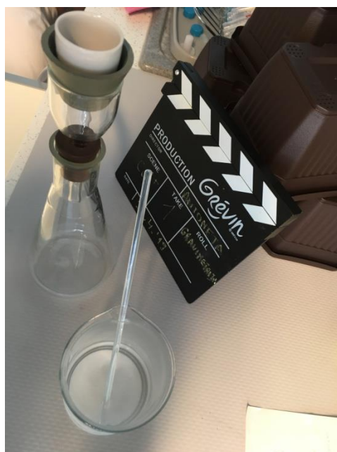
Slika 2-11 Uzorak spreman za filtriranje lijevkom za odsis
