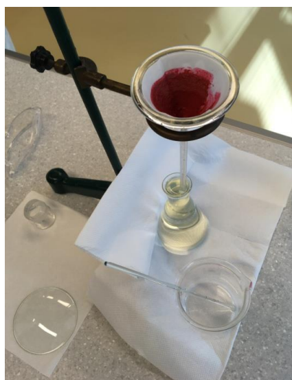
Slika 2-8 Filtracija otopine kroz lijevak
