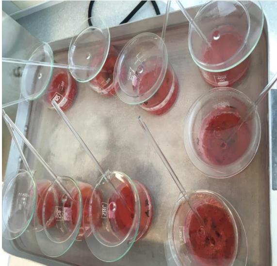
Slika 2-7 Digeriranje u vodenoj kupelji
