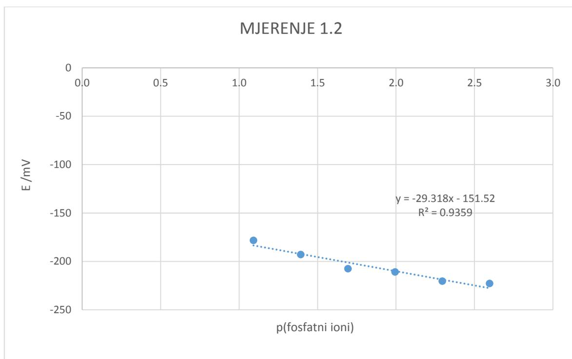
Slika 15. Prikaz odziva membrane na fosfatne ione
