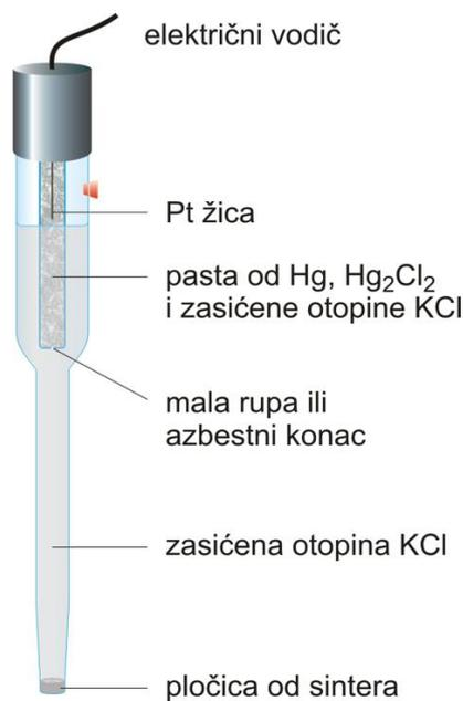
Slika 3. Prikaz zasićene Kalomelove elektrode <sup>2</sup>
