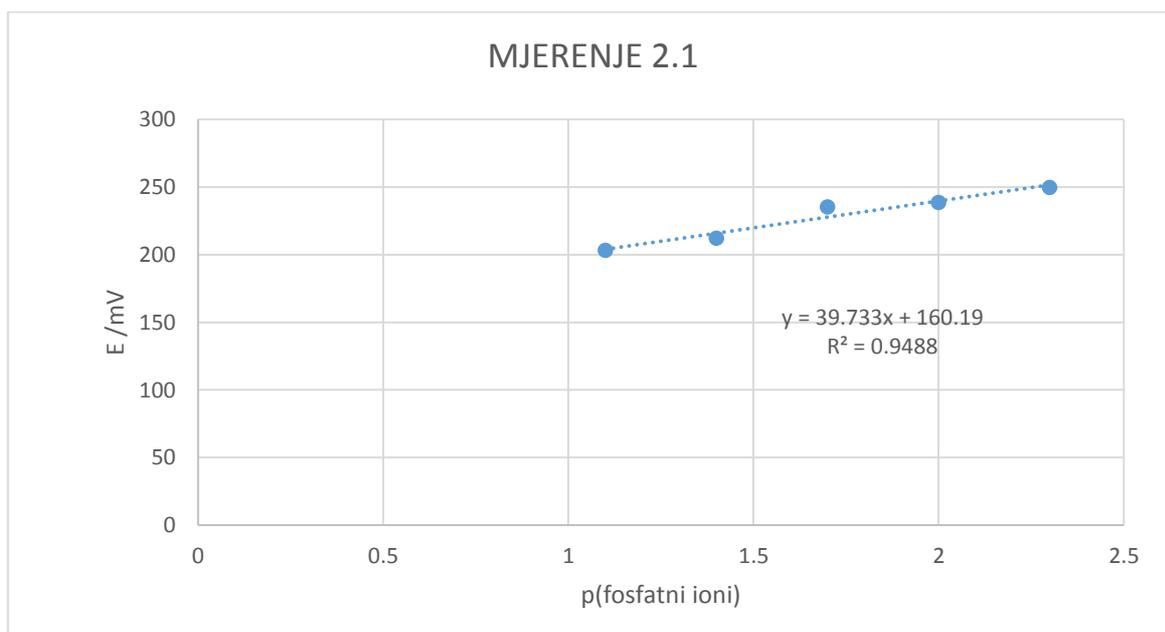
Slika 17. Prikaz odziva membrane na fosfatne ione
