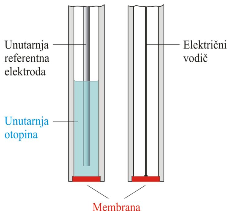
Slika 7. Prikaz elektrode s kristalnom membranom <sup>2</sup>
