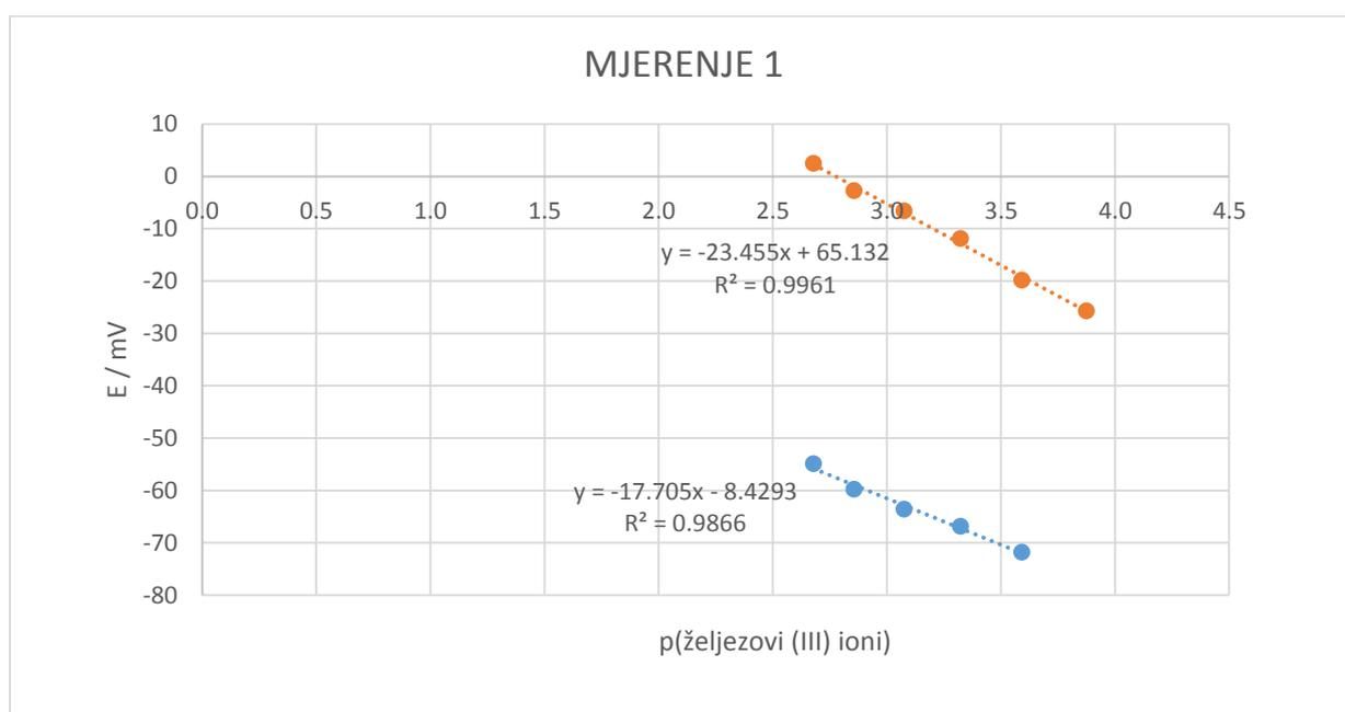
Slika 20. Prikaz odziva membrane na željezove ( III) ione
