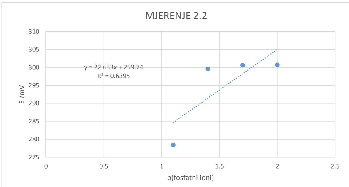
Slika 18. Prikaz odziva membrane na fosfatne ione
