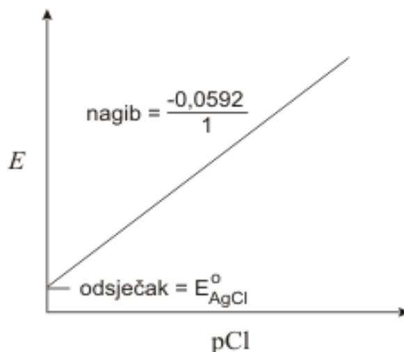
Slika 6. Prikaz ovisnosti koncentracije kloridnih iona o potencijalu elektrode II.reda <sup>2</sup>
