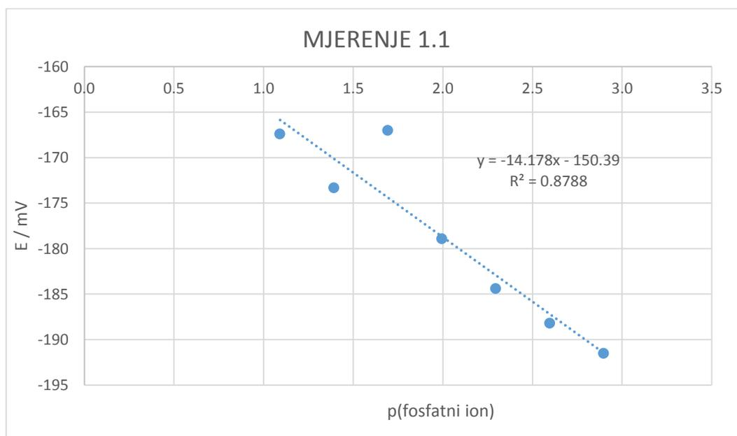
Slika 14. Prikaz odziva membrane na fosfatne ione
