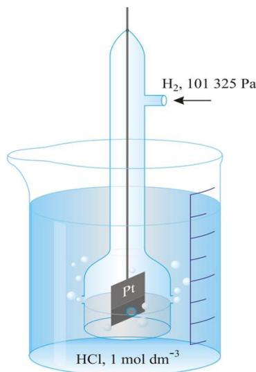
Slika 2. Prikaz standardne vodikove elektrode <sup>2</sup>
