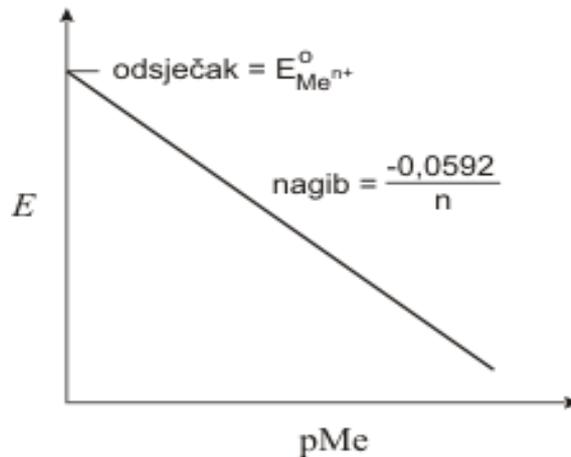
Slika 5. Prikaz ovisnosti koncentracije metalnih iona o potencijalu elektrode I. reda <sup>2</sup>
