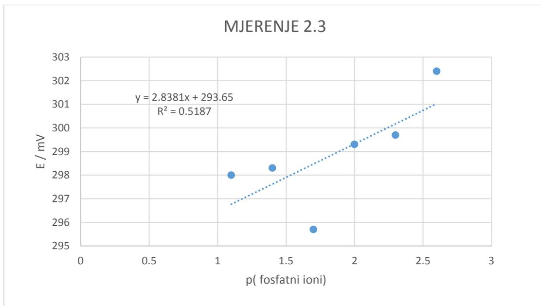
Slika 19. Prikaz odziva membrane na fosfatne ione
