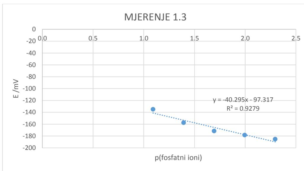
Slika 16. Prikaz odziva membrane na fosfatne ione
