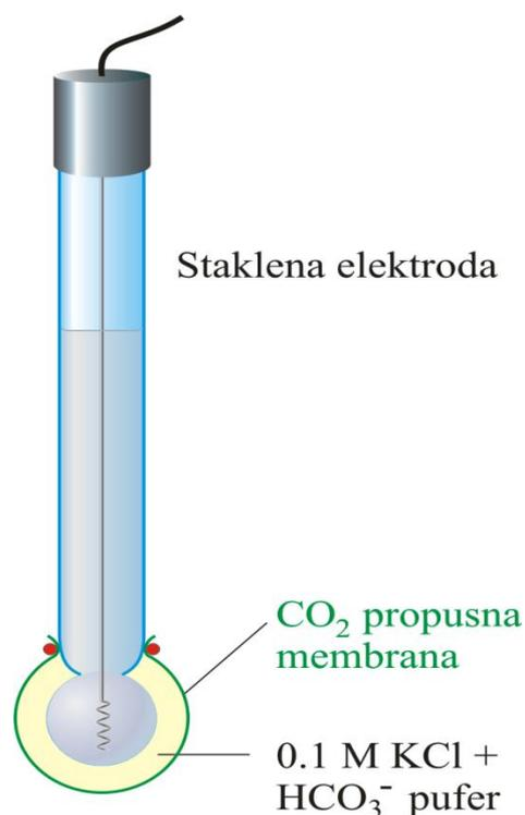
Slika 8. Prikaz elektrode za plinove <sup>2</sup>
