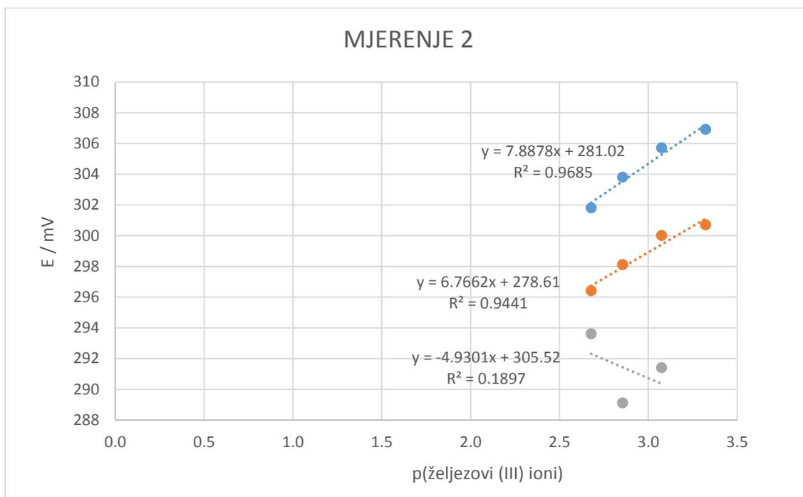
Slika 21. Prikaz odziva membrane na željezove (III) ione
