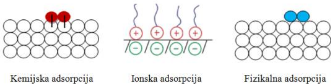
Slika 1.14. Shematski prikaz različitih adsorpcijskih procesa 26
