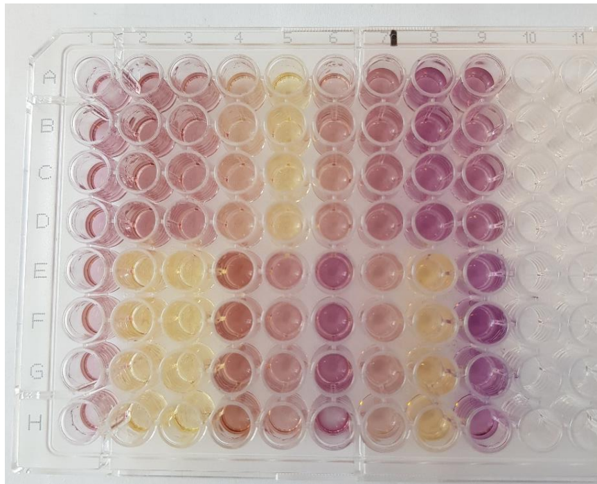
Slika 2.5. Mikrotitarska pločica s uzorcima za testiranje sposobnosti hvatanja DPPH radikala uzorcima hidrolata biljaka
