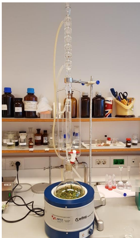
Slika 2.1. Aparatura po Clevengeru
