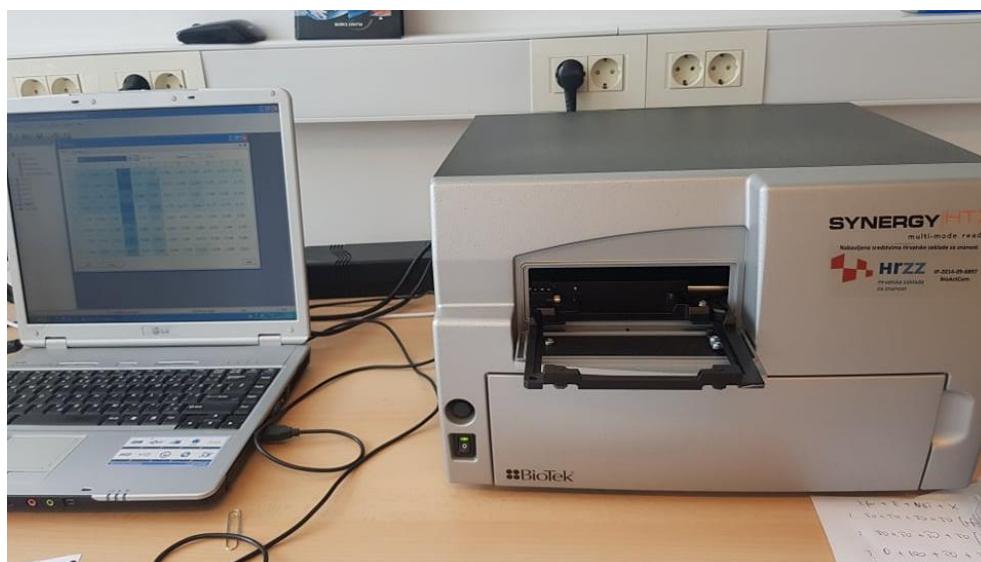
Slika 2.3. BioTek Synergy HTX multi-mode čitač
