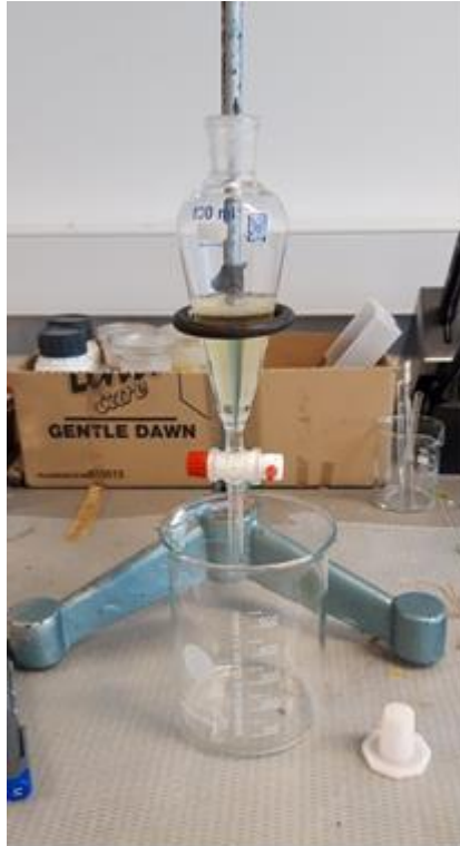
Slika 21. Obrada ekstrakta nakon mikrovalne ekstrakcije.
