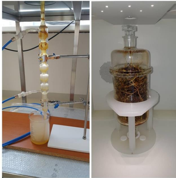
Slika 24. Pougljenje biljnog materijala tijekom mikrovalne ekstrakcije pri 97 °C.
