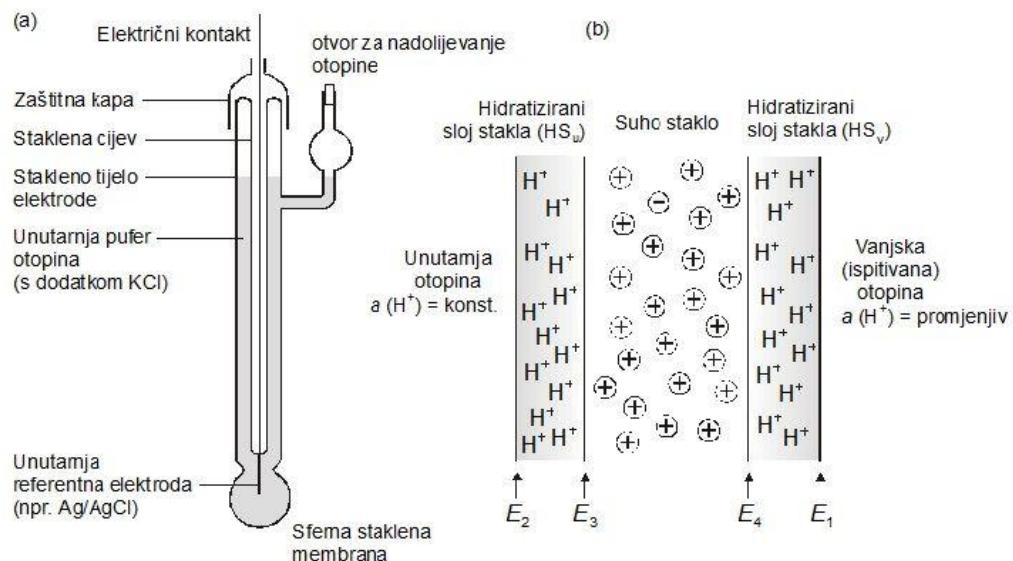
**Slika 5.** Staklena elektroda (a) i presjek kroz staklenu membranu (b)<sup>7</sup>
