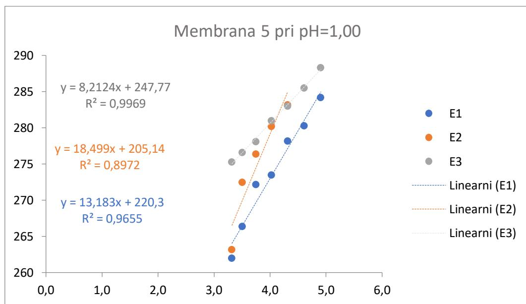
**Slika 13.** Prikaz testiranja odziva membrane M5 na željezove(III) ionu pri pH = 1,00
