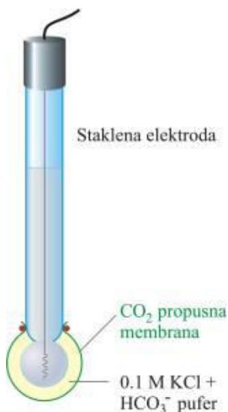
*Slika 6.* Shematski prikaz elektrode za plinove<sup>8</sup>
