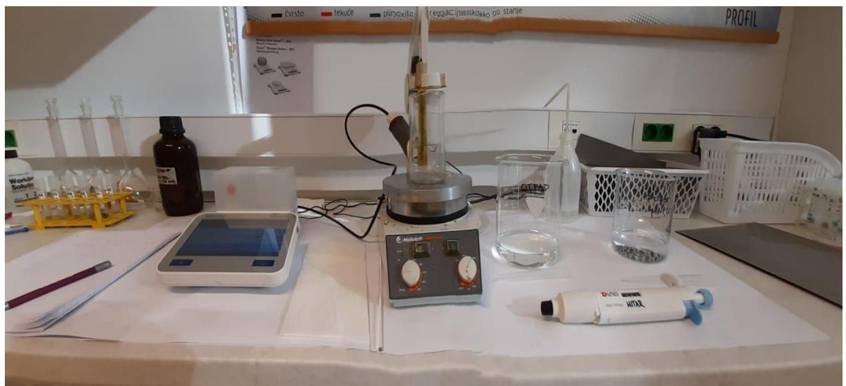
*Slika 10.* Aparatura za potenciometrijsko mjerenje
