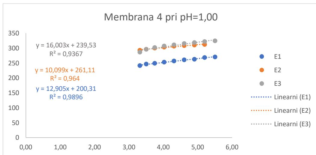
**Slika 17.** Prikaz testiranja odziva membrane M4 na željezove(III) ione pri  $\text{pH} = 1,00$ . III. testiranje
