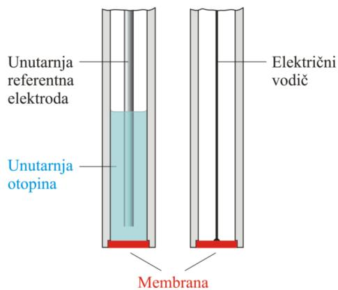
*Slika 4.* Izgled elektrode s kristalnom membranom<sup>8</sup>
