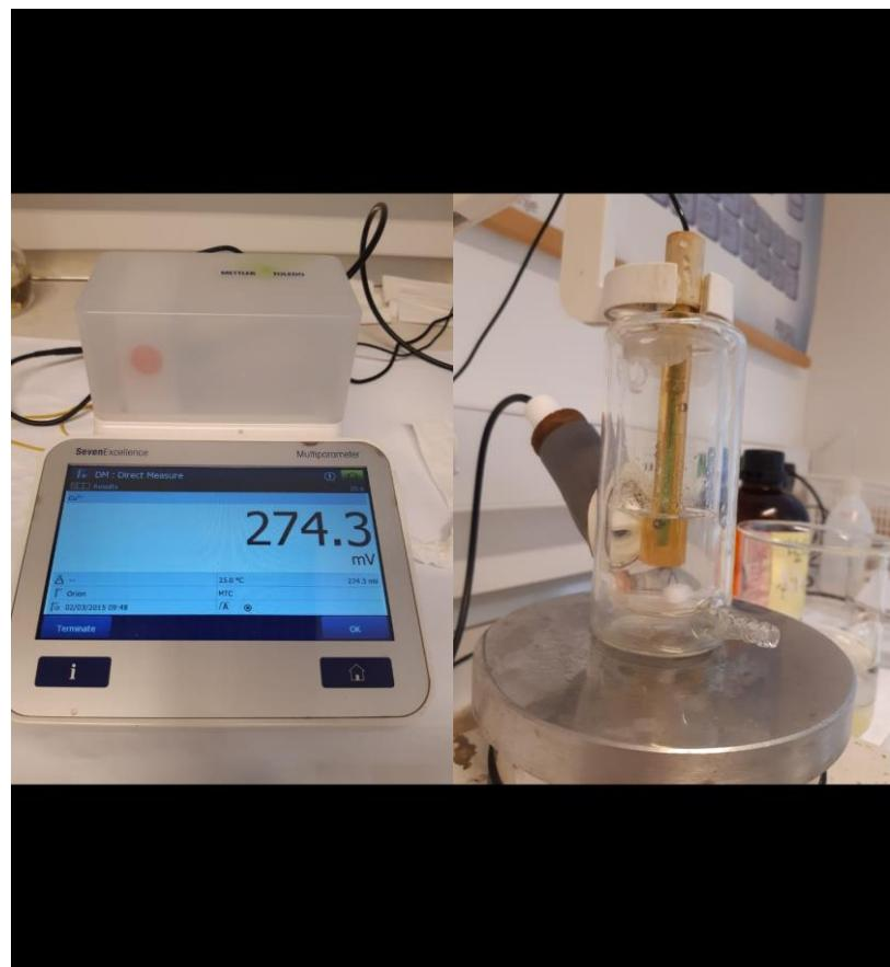
**Slika 12.** Milivoltmetar koji prikazuje izmjereni potencijal (lijevo) i referentna elektroda uronjena u čeliju s magnetskom miješalicom (desno)
