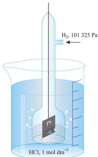
*Slika 7.* Standardna vodikova elektroda<sup>8</sup>
