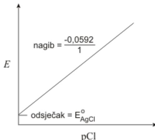
*Slika 3.* Ovisnost koncentracije kloridnih iona o potencijalu elektrode II. reda<sup>8</sup>
