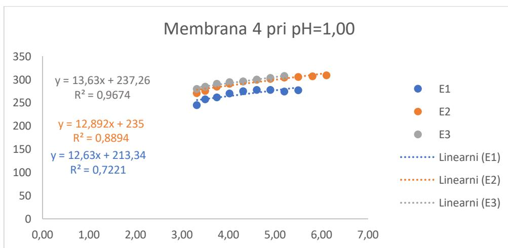
**Slika 16.** Prikaz testiranja odziva membrane M4 na željezove(III) ione pri  $\text{pH} = 1,00$ . II. testiranje
