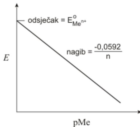
*Slika 2.* Ovisnost koncentracije metalnih iona o potencijalu elektrode I. reda<sup>8</sup>
