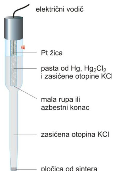
*Slika 8.* Shematski prikaz zasićene kalomelove elektrode
