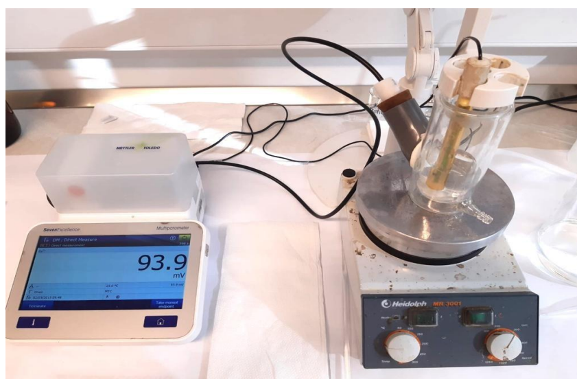
Slika 12. Prikaz aparature za potenciometrijsko mjerenje
