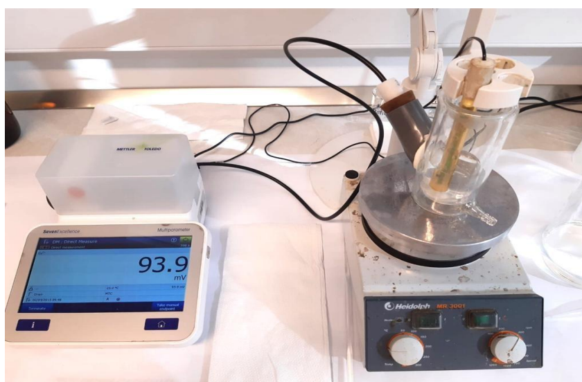
Slika 12. Prikaz aparature za potenciometrijsko mjerenje
