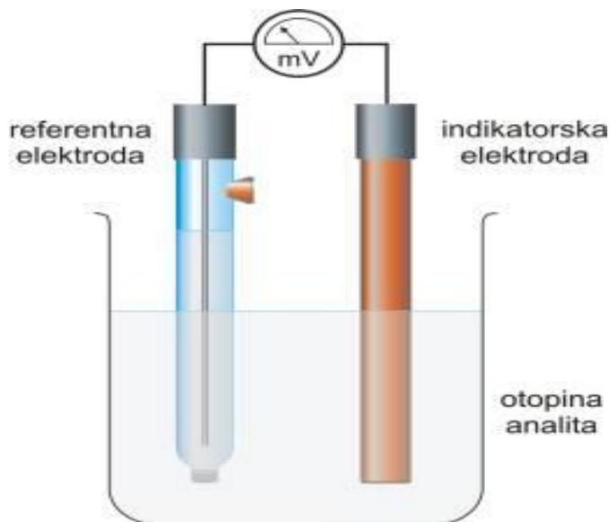
*Slika 1. Ćelija sa elektrodnim parom<sup>6</sup>*
