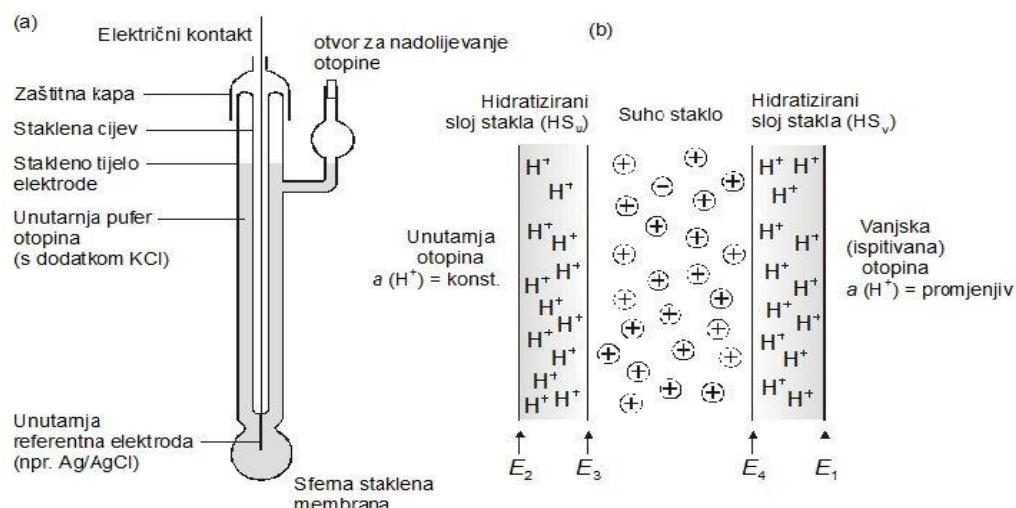
*Slika 9. a) staklena elektroda i b) presjek kroz staklenu elektrodu*<sup>3</sup>
