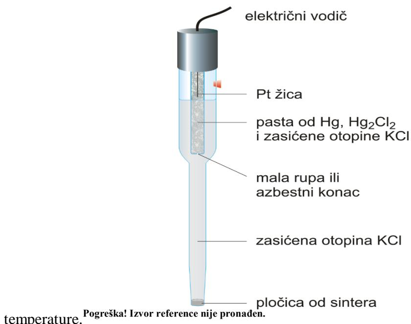
*Slika 5. Kalomelova elektroda<sup>6</sup>*
