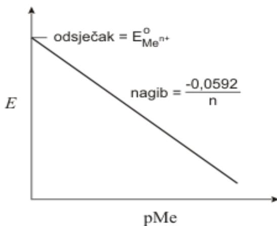
*Slika 6.* Graf ovisnosti koncentracije metalnih iona o potencijalu elektrode I. reda<sup>6</sup>
