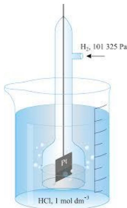
*Slika 3. Standardna vodikova elektroda<sup>1</sup>*
