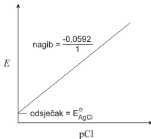
*Slika 7.* Ovisnost koncentracije kloridnih iona o potencijalu elektrode II. reda<sup>6</sup>
