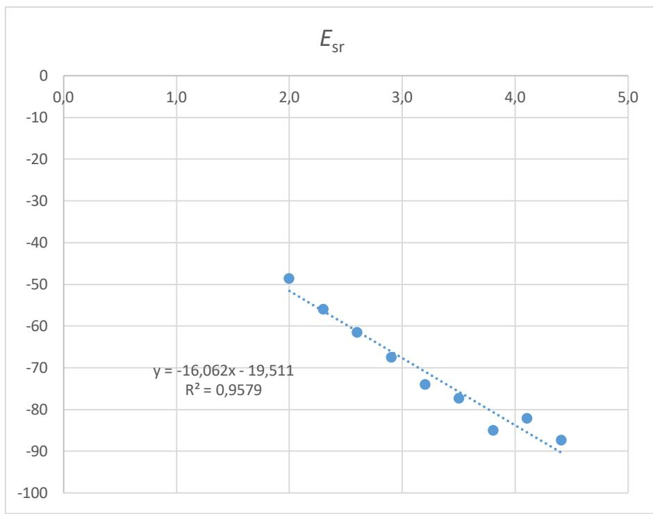
Slika 13. Grafički prikaz artimetičke vrijednosti potencijala M1;  $c(\text{FeCl}_3)$ ; pH=1
