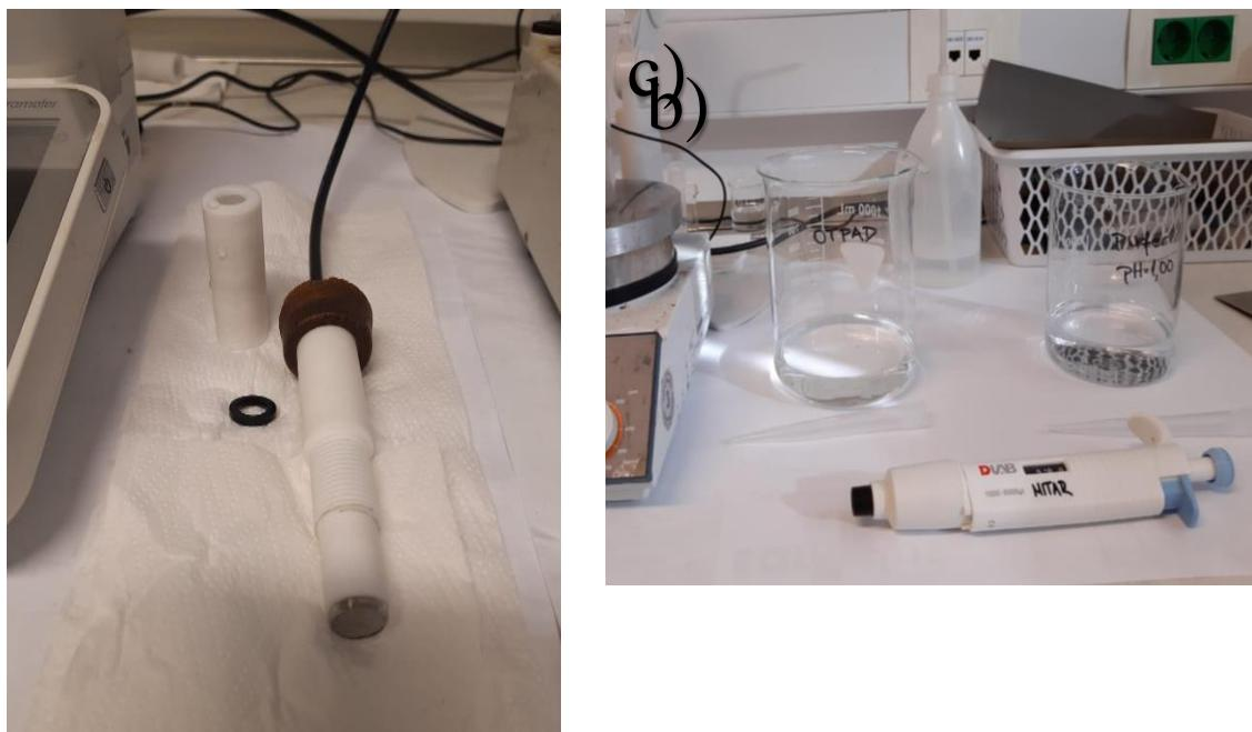
Slika 11. a) Aparatura za potenciometriju b) Tijelo elektrode u koju se postavlja membrana za ispitivanje c) čaša za otpad i čaša za pufer kojim razrjeđujemo, mikropipeta
