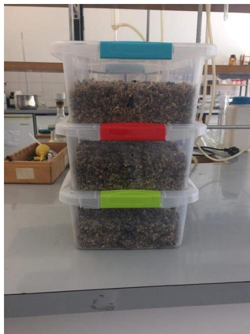
Slika 12. Vanjski izgled reaktora za kompostiranje
