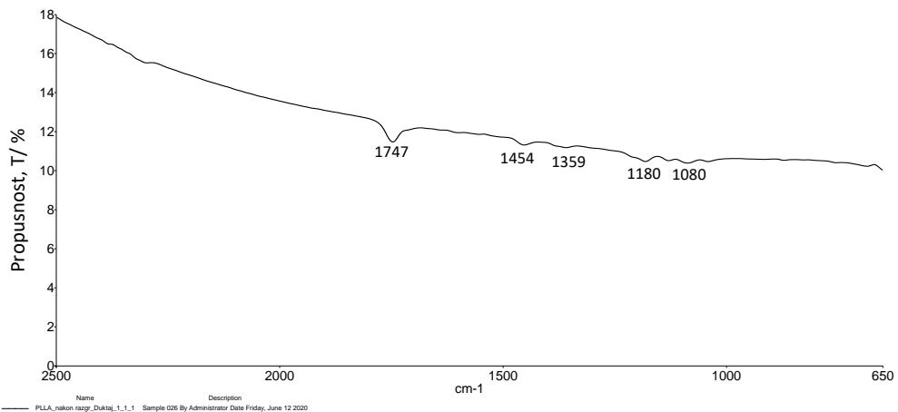
Slika 20. FT-IR spektar ostataka uzorka PLA nakon kompostiranja
