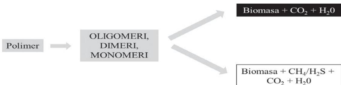
Slika 3. Shema aerobne i anerobne razgradnje<sup>3</sup>
