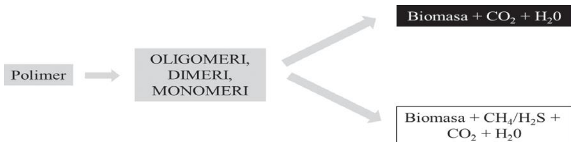
Slika 3. Shema aerobne i anerobne razgradnje 3
