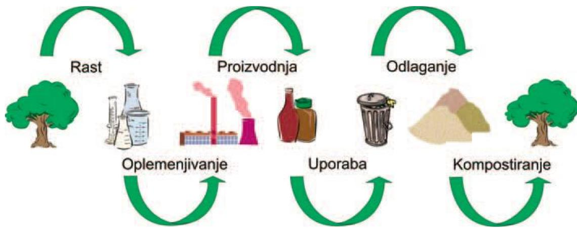
Slika 2. Tijek životnog ciklusa biorazgradljivog, kompostabilnog, polimernog materijala<sup>6</sup>
