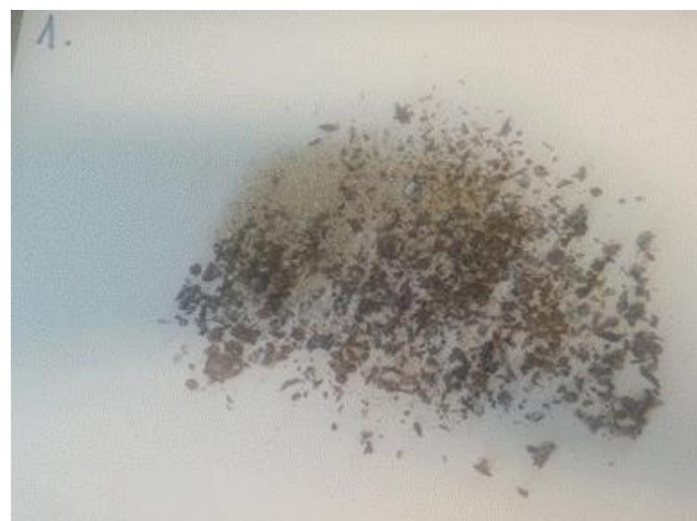
Slika 15. Osušeni uzorci PLLA (sitni svjetlijici komadići) iz reaktora 1
