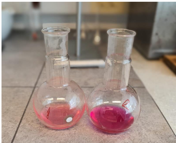
Slika 14. Uzorci nakon titracije s KOH
