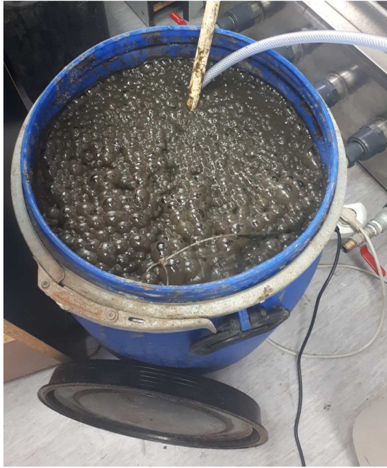
Slika 2.8. Simulirajući SBR s jednim difuzorom.
