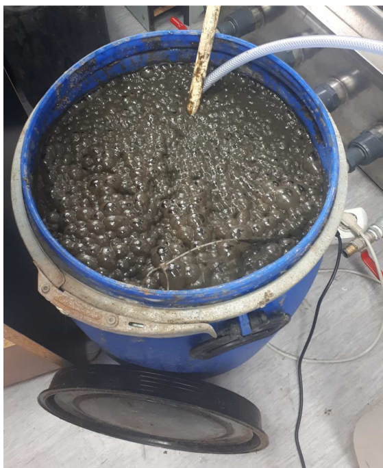
Slika 2.8. Simulirajući SBR s jednim difuzorom.
