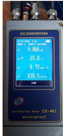
Slika 2.2. Uređaj za mjerenje kisika.
