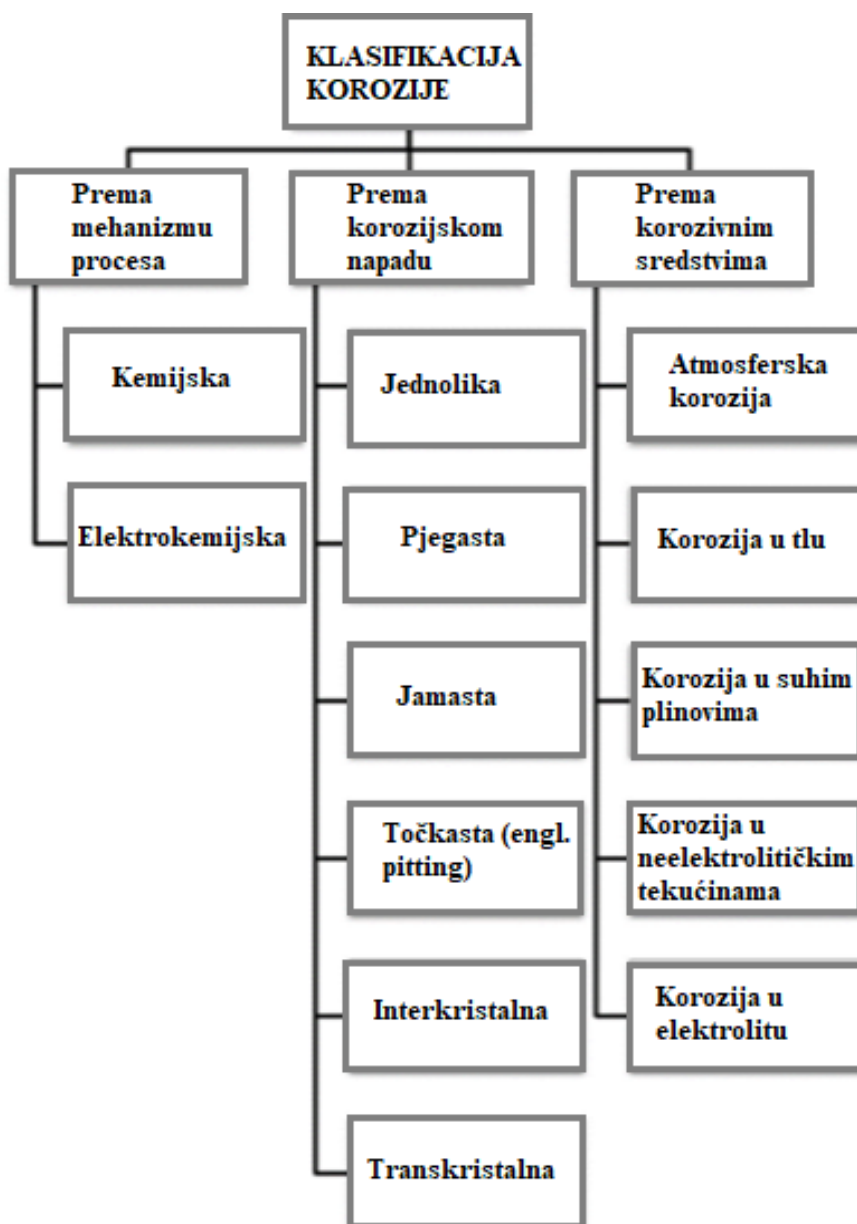
Slika 5. Klasifikacijska korozijskih procesa. 14
