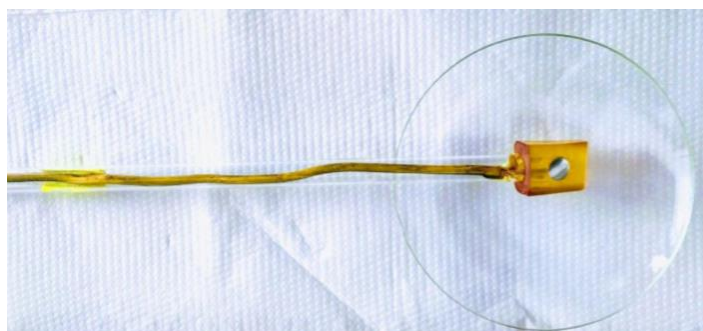
Slika 21. Radna Sn elektroda. 40
