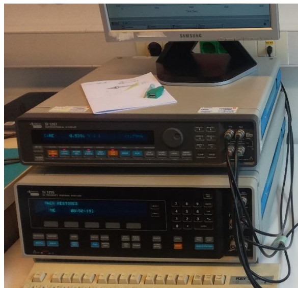
Slika 23. Potenciostat/galvanostat "Solartron SI 1287".
