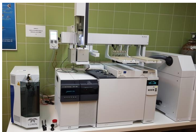
Slika 26. Vezani sustav plinska kromatografija-spektrometrija masa (GC-MS)
