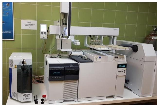
**Slika 26.** Vezani sustav plinska kromatografija-spektrometrija masa (GC-MS)
