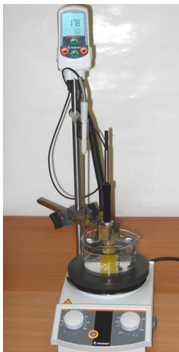
Slika 24. Aparatura za mikroekstrakciju vršnih para na krutoj fazi (HS-SPME)
