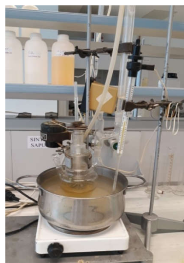
Slika 10. Aparatura za sintezu sapuna
