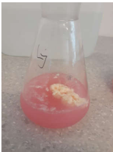
Slika 11. Promjena boje metiloranža i izlučivanje masnoća
