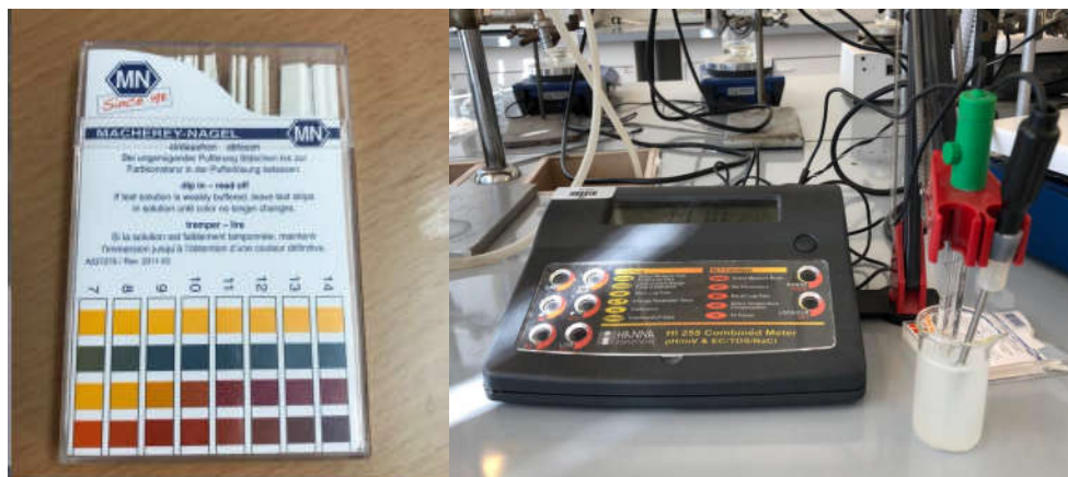
Slika 16. Lijevo: Ph papir marke „Macherey – Nagel“, desno: pH metar
