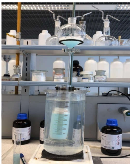
Slika 17. Aparatura za određivanje moći pjenjenja
