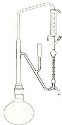
Slika 11. Aparatura za izolaciju eteričnih ulja prema Evropskoj farmakopeji
