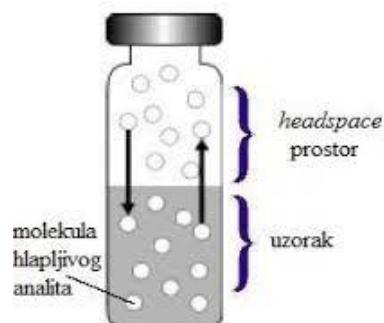
Slika 15. Shematski prikaz *headspace* uzorkovanja
