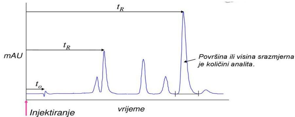
Slika 17. Kromatogram sa prikazom mrtvog vremena  $t_o$  i retencijskog vremena  $t_R$
