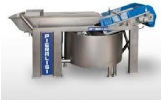
Slika 8. Hidropneumatski stroj za pranje maslina – perilica (12)
