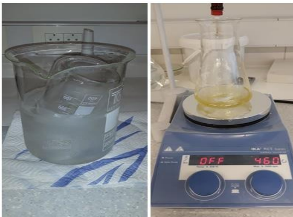
Slika 6. Aparatura za sintezu koloidnog srebra a) ledena kupelj b) reakcijska tikvica
