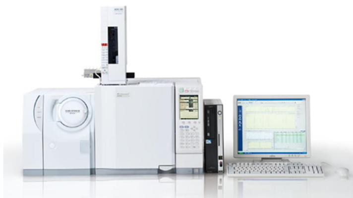
Slika 7. Plinski kromatograf sa spektrometrom masa; Shimadzu GCMS-QP2010 (35).
