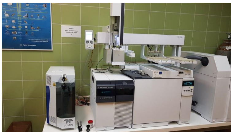
Slika 13. Vezani sustav plinska kromatografija-spektrometrija masa (GC-MS)
