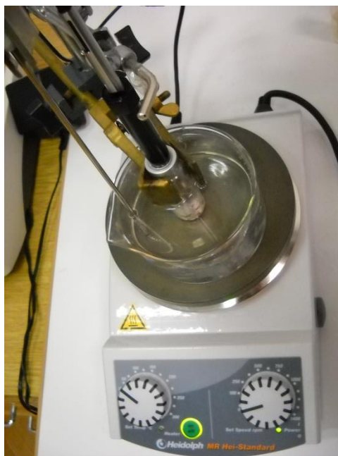
Slika 12. Aparatura za pripremu uzorka za HS-SPME (32)
