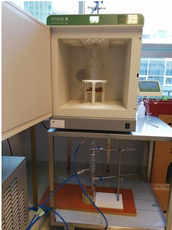
Slika 7. Aparatura za dobivanje aroma
