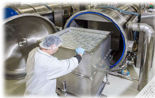
Slika 3. Termička obrada konzervirane ribe 4
