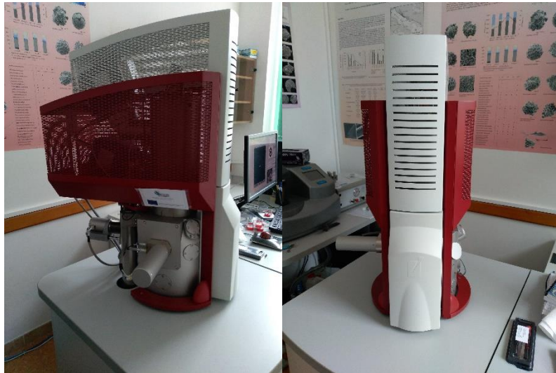
Slika 13. Pretražni elektronski mikroskop Tescan Mira 3
