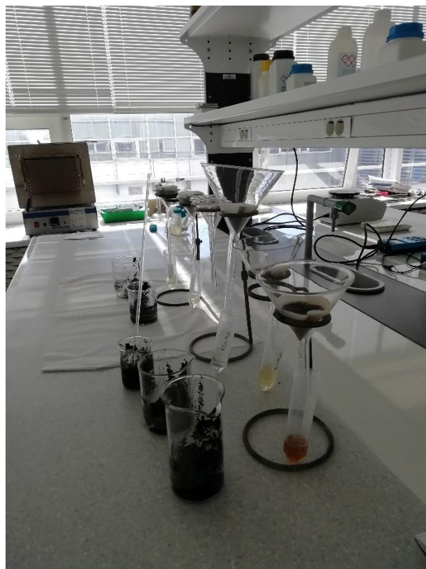
Slika 2.11 Filtriranje suspenzija preko filter papira
