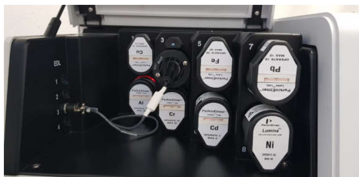
Slika 10. Žarulje sa šupljom katodom
