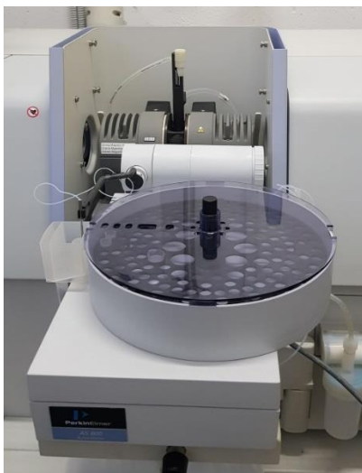
Slika 11. Podložak s uzorcima i samouzorkivač
