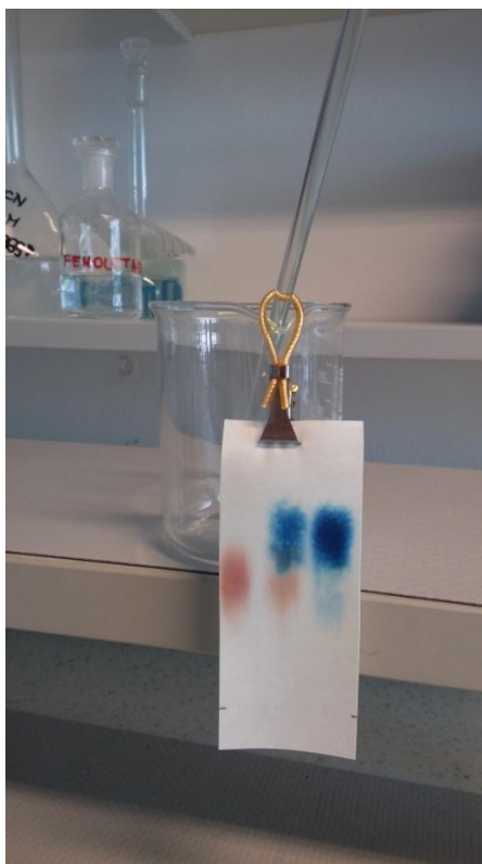
Slika 4.2. Kromatografska pločica nakon vizualizacije
