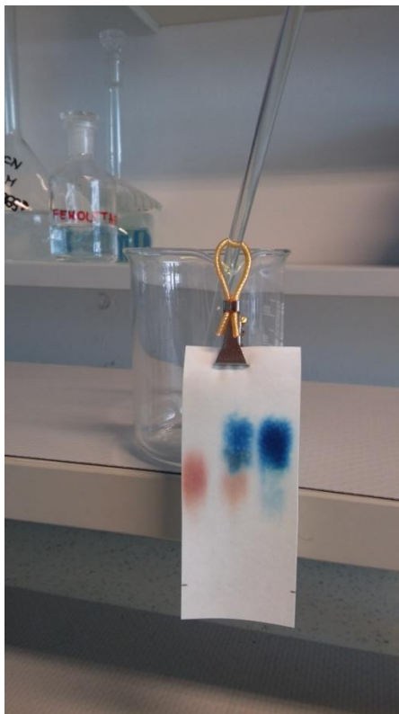
Slika 4.2. Kromatografska pločica nakon vizualizacije
