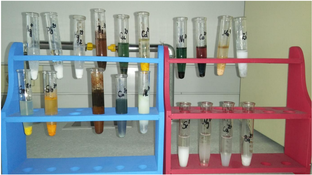
Slika 4.7. Uzorci kationa nakon dodatka odgovarajućeg taložnog reagensa
