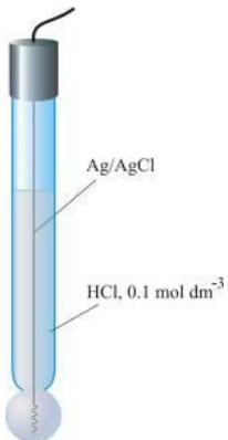
Slika 5. Shematski prikaz elektrode s nekristaličnom membranom
