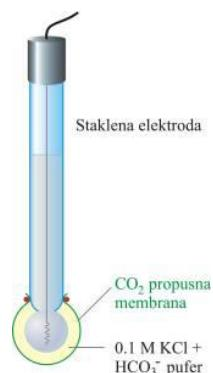
Slika 6. Prikaz elektrode za plinove ( $CO_2$ )
