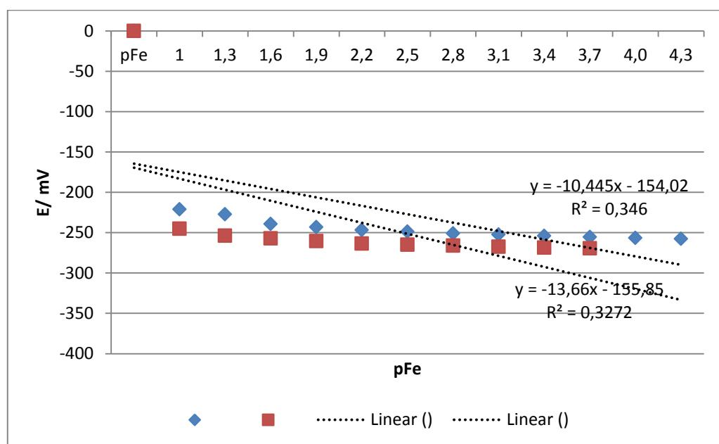
Slika 13.Prikaz ispitivanja odziva elektrode na Fe<sup>2+</sup> ione
