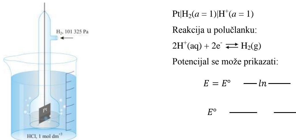
Slika 7. Standardna vodikova elektroda
