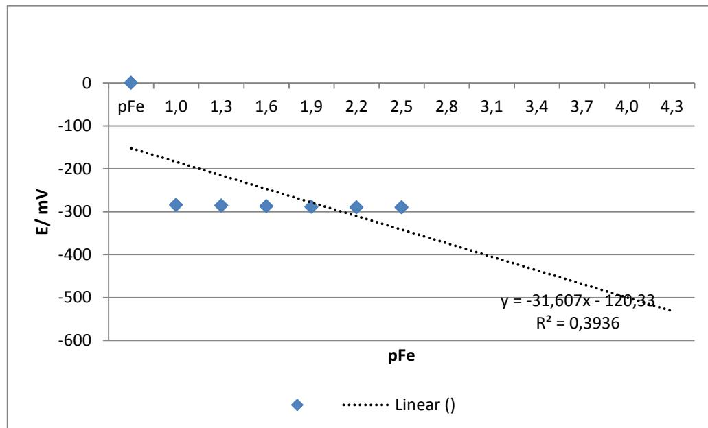
Slika 14. Prikaz ispitivanja odziva elektrode na Fe<sup>2+</sup> ione
