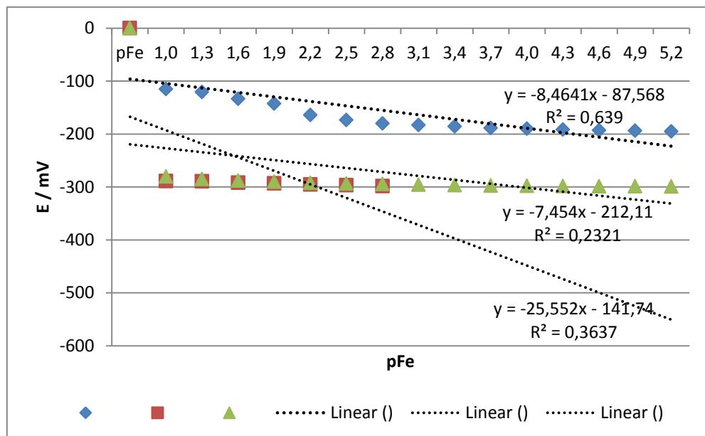
Slika 15. Prikaz ispitivanja odziva elektrode na Fe<sup>2+</sup> ione
