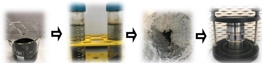
TALOŽENJE - CENTRIFUGIRANJE – VAKUUM SUŠENJE – PROSIJAVANJE
