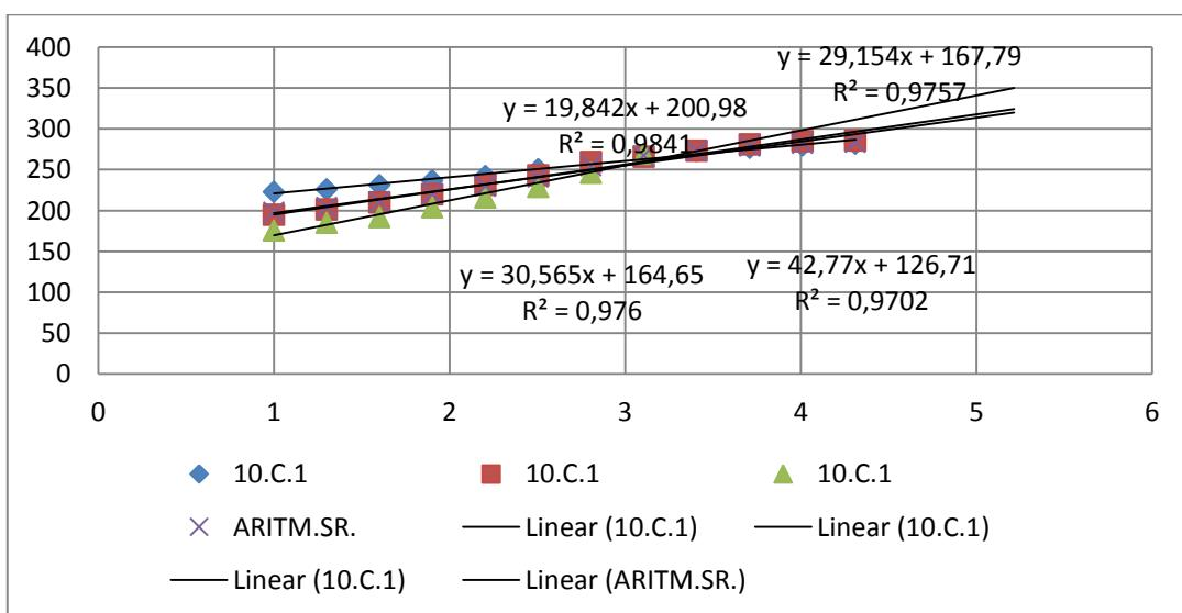
Slika 16. Prikaz ispitivanja odziva elektrode na Fe<sup>2+</sup> ione
