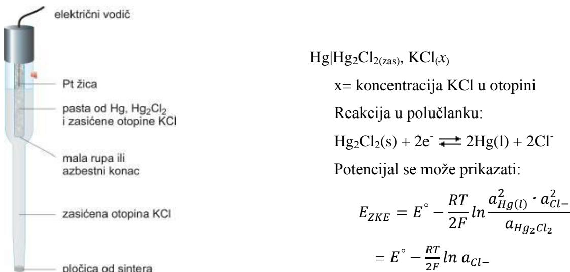
Slika 8. Zasićena kalomelova elektroda
