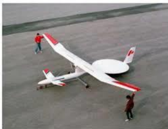
Slika 2.5. SHARP-ov avion na napajanje mikrovalovima. [25]
