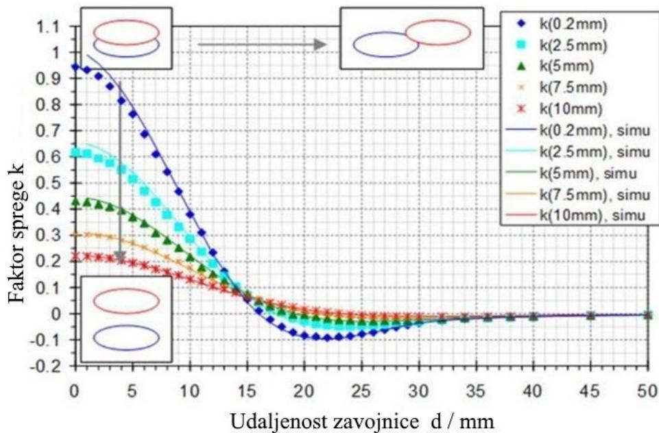
Slika 2.11. Ovisnost faktora sprege o udaljenosti zavojnica. [32]
