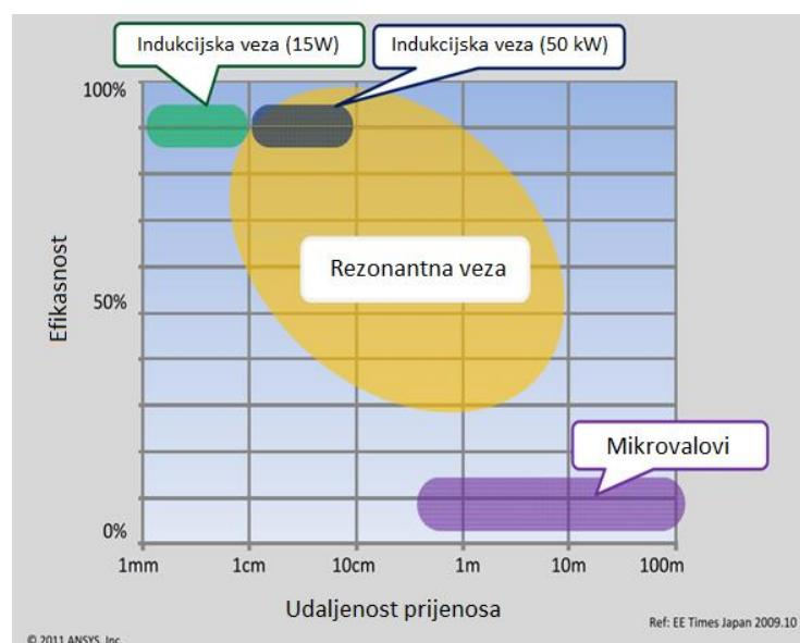
**Slika 2.13.** Efektivnost načina prijenosa energije s obzirom na udaljenost. <sup>[35]</sup>
