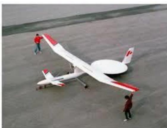
**Slika 2.5.** SHARP-ov avion na napajanje mikrovalovima.<sup>[25]</sup>
