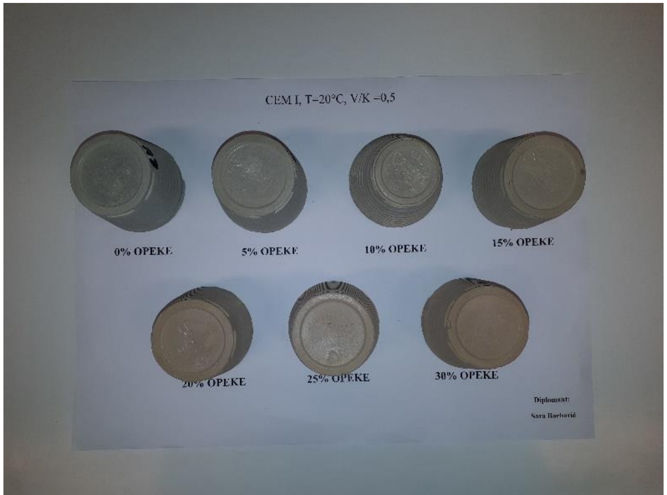
Slika 9: Uzorci cementnih pasti uz dodatak 0 - 30 mas.% otpadne građevinske opeke nakon određivanja specifične električne provodnosti
