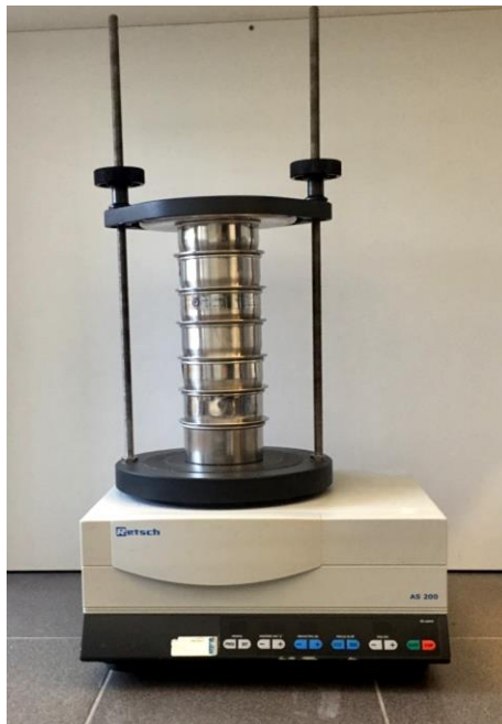
Slika 19. Aparatura za provedbu granulometrijske analize pomoću sita.
