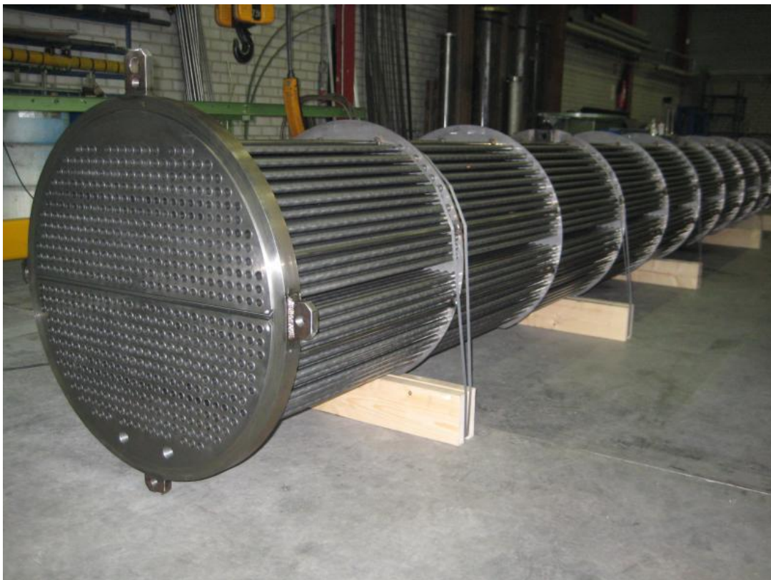
Slika 1.4. Izmjenjivač s učvršćenim snopom cijevi. 10
