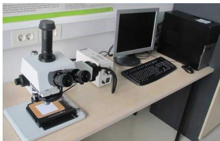
**Slika 16.** Optički mikroskop MXFMS-BD, Ningbo Sunny Instruments co.
