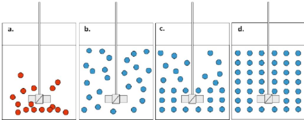
Slika 12. Stanja suspenzije: a. nepotpuna suspenzija, b. potpuna suspenzija, c. intermedijalna suspenzija, d. homogena suspenzija<sup>10</sup>
