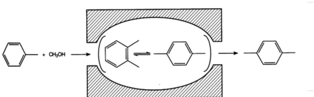
Slika 5. Primjer selektivnosti prema obliku molekule produkta (metiliranje toluena)<sup>7</sup>
