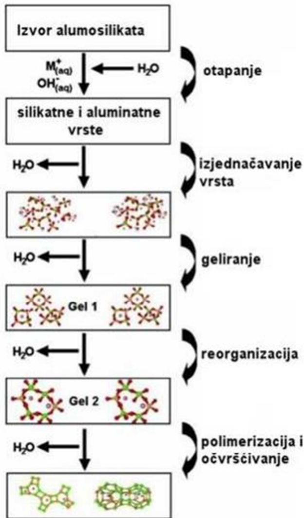
Slika 1.6. Duxsonov model geopolimerizacije. 2
