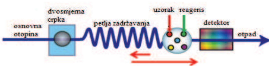
Slika 1-3 Shematski prikaz sustava za slijednu analizu injektiranjem. 12
