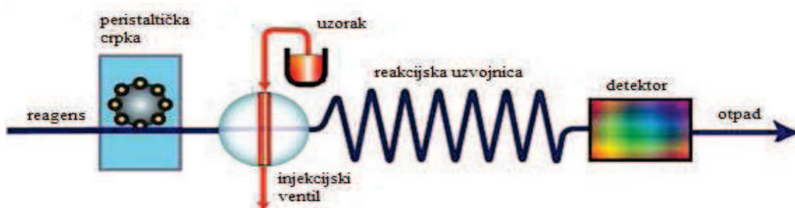
Slika 1-2 Shematski prikaz sustava za protočnu analizu injektiranjem. 9
