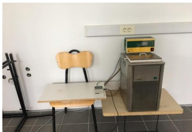
**Slika 11.** Aparatura za praćenje topline hidratacije
