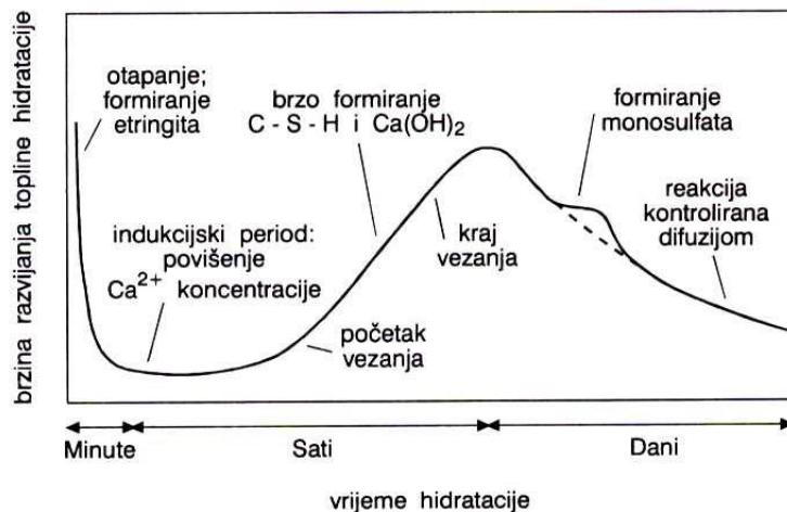
Slika 7. Shematski prikaz hidratacije portlandskog cementa<sup>5</sup>
