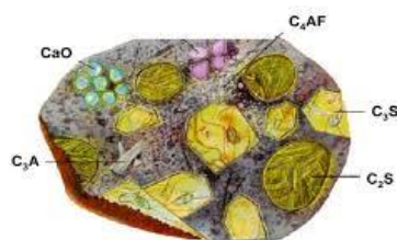
Slika 5. Slikovni prikaz poprečnog presjeka zrna cementa 5
