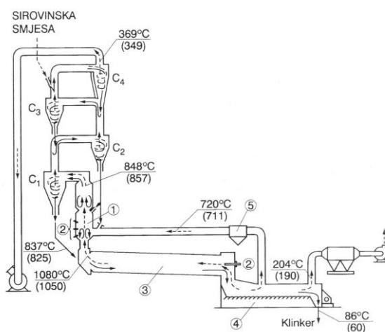
**Slika 4.** Shematski prikaz uređaja za proizvodnju (pečenje) PC klinkera s višestupanjskim predgrijivačem, kalcinatorom, rotacijskom peći i hladnjakom za klinker
