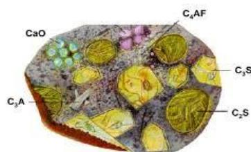
**Slika 5.** Slikovni prikaz poprečnog presjeka zrna cementa<sup>5</sup>
