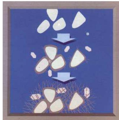
**Slika 6.** Shematski prikaz procesa hidratacije cementa<sup>9</sup>
