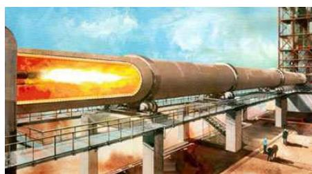
Slika 2. Rotacijska peć za proizvodnju PC klinkera<sup>5</sup>
