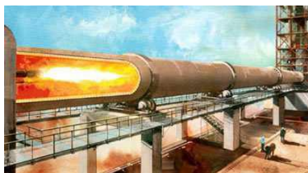
Slika 2. Rotacijska peć za proizvodnju PC klinkera 5
