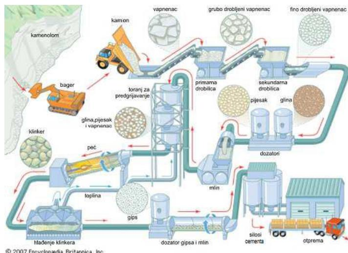
**Slika 3.** Shema proizvodnje portlandskog cementa<sup>6</sup>
