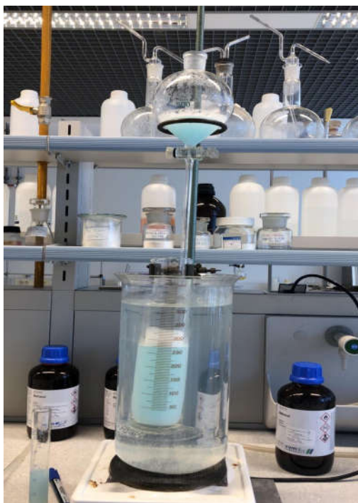
Slika 16. Aparatura za određivanje moći pjenjenja
