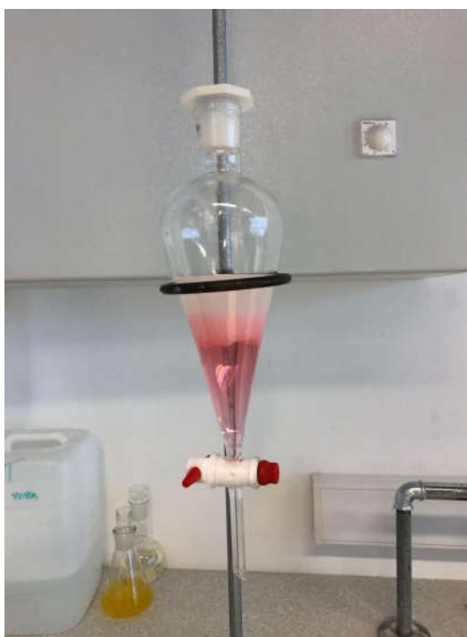
Slika 13. Lijevak za odjeljivanje s vodenom i petroleterskom fazom
