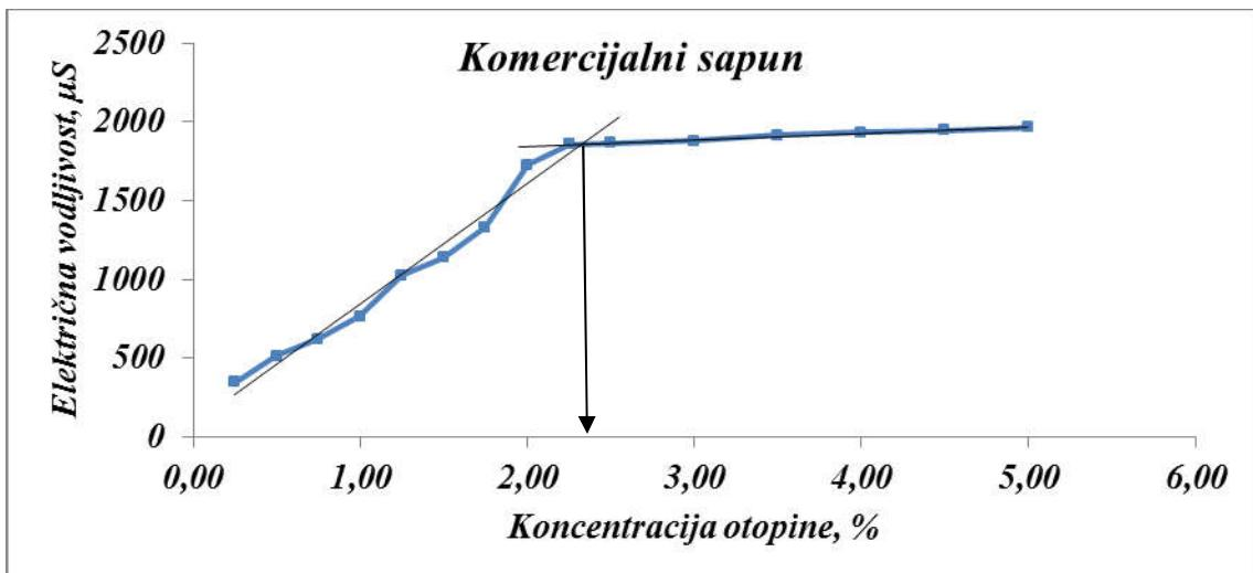
Slika 21. Ovisnost električne vodljivosti otopine komercijalnog sapuna o koncentraciji otopine
