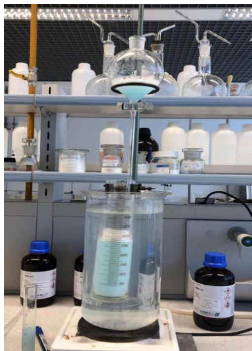
Slika 16. Aparatura za određivanje moći pjenjenja
