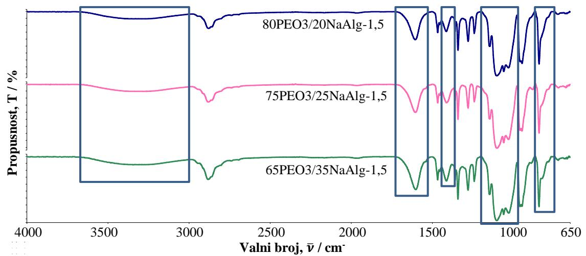
**Slika 18.** FT-IR spektri filmova polimernih mješavina PEO<sub>3</sub>/NaAlg (80/20, 75/25 i 65/35) pripremljenih iz 1,5 mas% početnih polimernih otopina
