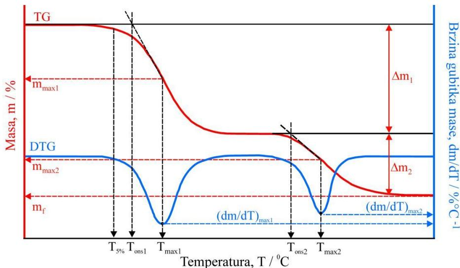
Slika 9. Određivanje značajki termogravimetrijskih krivulja
