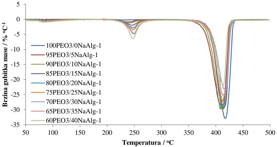
**Slika 38.** DTG krivulje neizotermne toplinske razgradnje filmova polimernih mješavina PEO3/NaAlg pripremljenih iz 1 mas% početnih polimernih otopina
