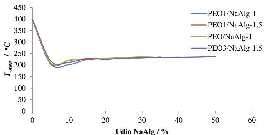
**Slika 41.** Ovisnost  $T_{onset}$  o udjelu NaAlg-a kod II. stupnja razgradnje filmova polimernih mješavina PEO/NaAlg
