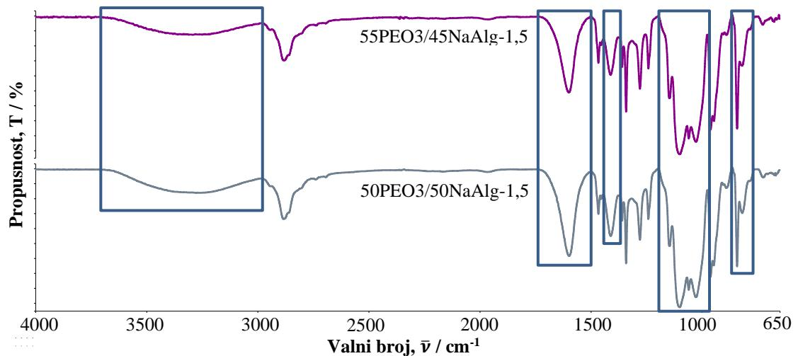
**Slika 19.** FT-IR spektri filmova polimernih mješavina PEO<sub>3</sub>/NaAlg (55/45 i 50/50) pripremljenih iz 1,5 mas% početnih polimernih otopina
