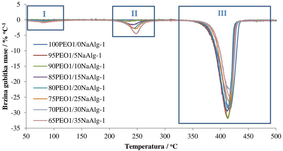
**Slika 36.** DTG krivulje neizotermne toplinske razgradnje filmova polimernih mješavina PEO1/NaAlg pripremljenih iz 1 mas% početnih polimernih otopina
