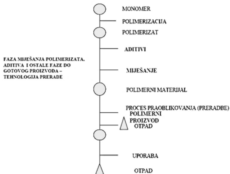
**Slika 2.** Faze tehnološkog procesa proizvodnje polimernih proizvoda<sup>7</sup>
