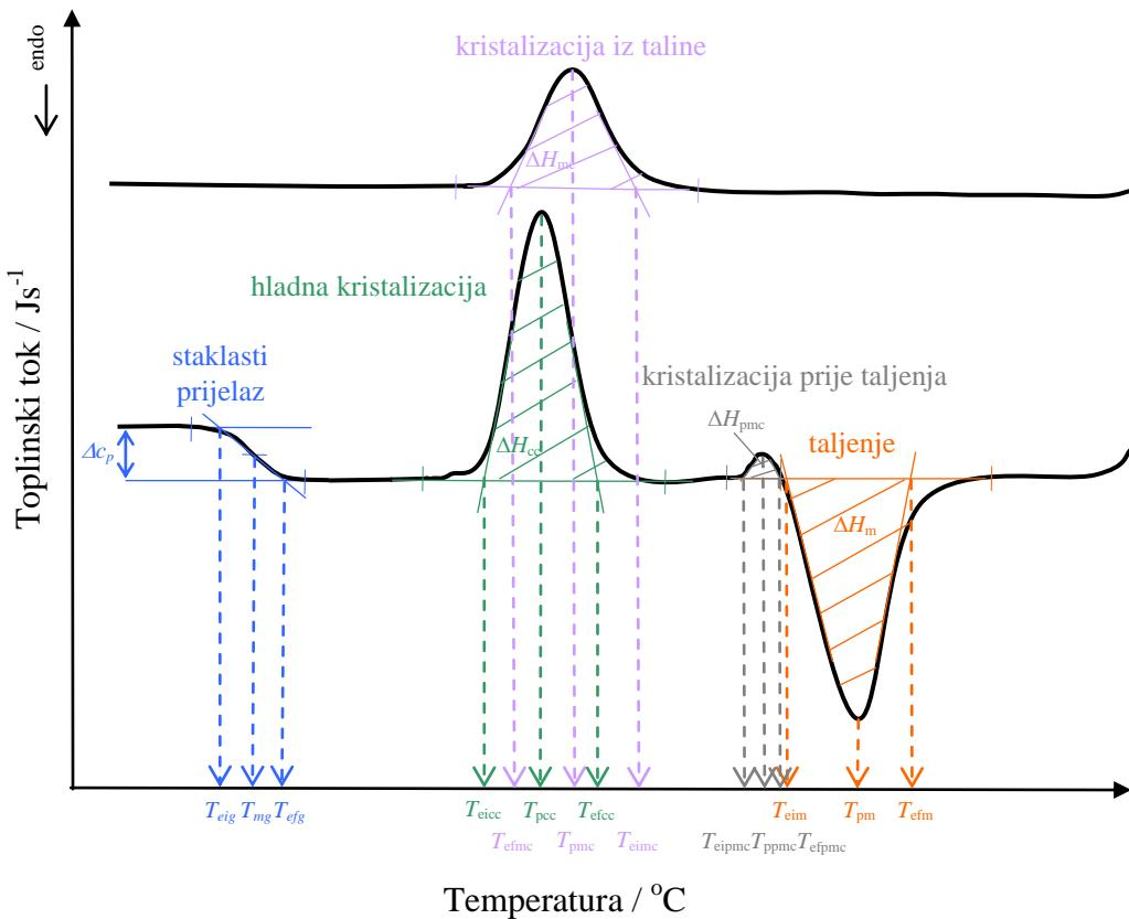
**Slika 8.** Određivanje značajki krivulje diferencijalne pretražne kalorimetrije
