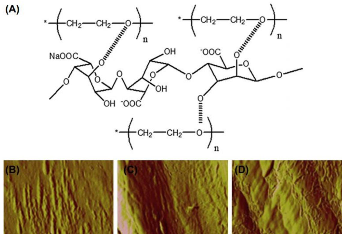
**Slika 3.** Vodikova veza između PEO-a i NaAlg-a (A); slike mikroskopa atomskih sila (AFM) čistog PEO-a (B), PEO-NaAlg (9 mas% NaAlg) (C), PEO-NaAlg (50 mas% NaAlg) (D)<sup>14,15</sup>
