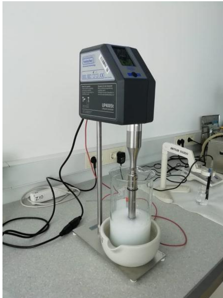
Slika 2.3. Ultrazvuk visokog intenziteta Hielscher UP400St.
