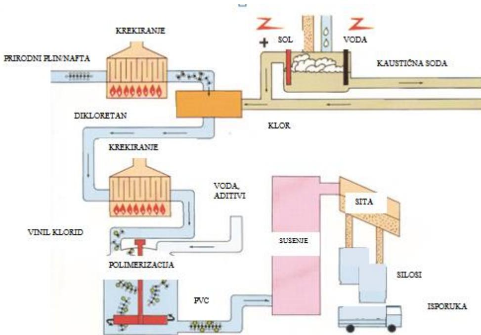
Slika 4. Shematski prikaz proizvodnje PVC-a<sup>7</sup>
