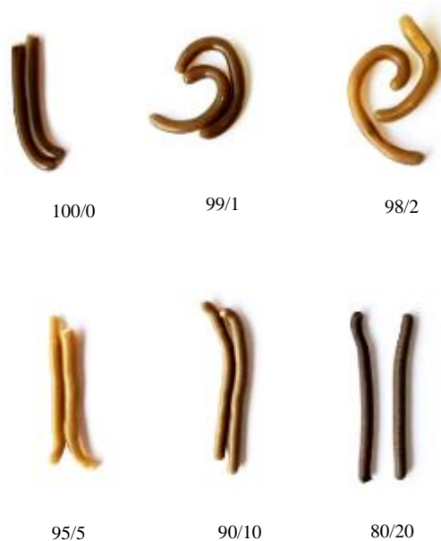
Slika 18. Uzorci mješavina PVC/ES dobiveni ekstrudiranjem pri 170 °C.
