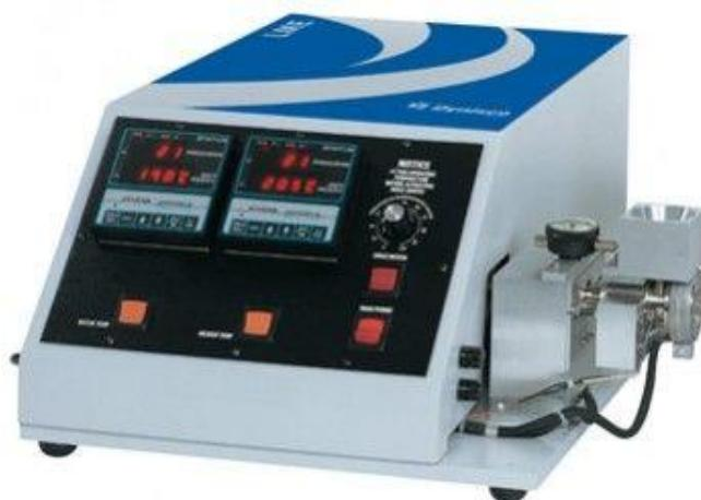
Slika 14. Laboratorijski jednopužni ekstruder Dynisco (Qualitest, SAD)
