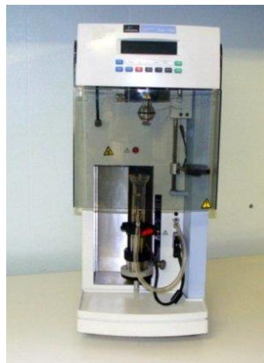
Slika 15. Termogravimetar Pyris 1 TGA (Perkin-Elmer, SAD).
