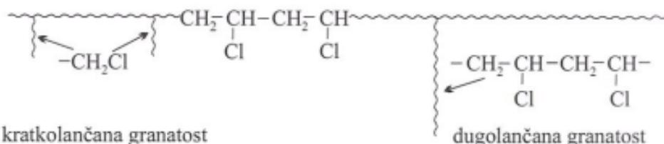
Slika 2. Prikaz temeljnih vrsta granate strukture makromolekula PVC-a<sup>7</sup>
