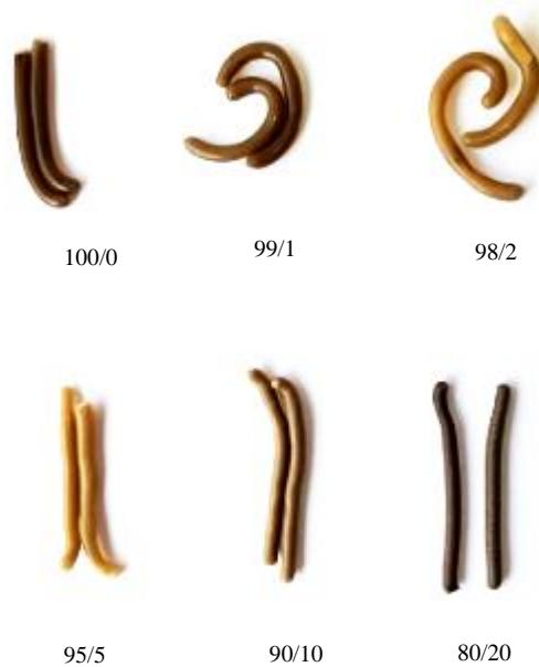
Slika 18. Uzorci mješavina PVC/ES dobiveni ekstrudiranjem pri 170 °C.
