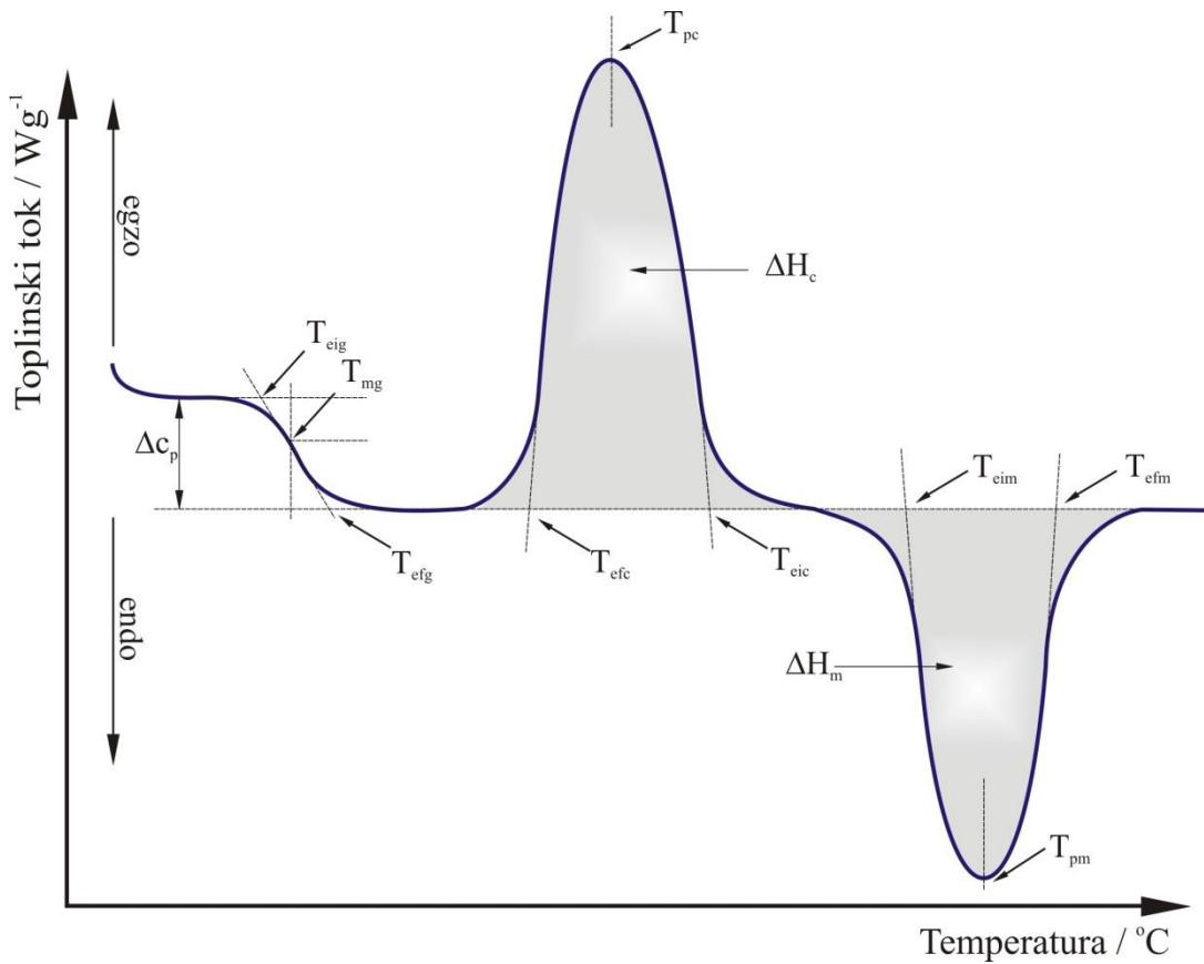
Slika 12. Određivanje značajki krivulje diferencijalne pretražne kalorimetrije u inertu<sup>33</sup>
