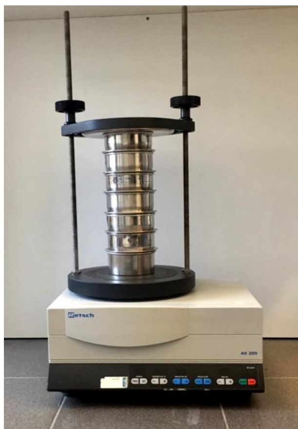
Slika 25. Aparatura za provedbu granulometrijske analize prosijavanjem.
